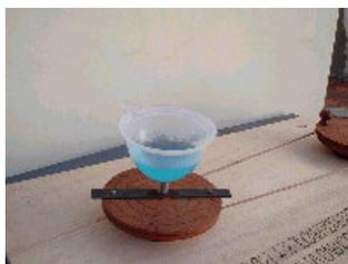
Figura 4: Experimento do líquido em rotação (espelho parabólico).
