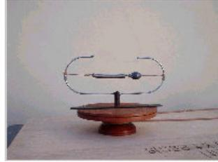
Figura 14: Material utilizado para o experimento da força elástica como resultante centrípeta.
