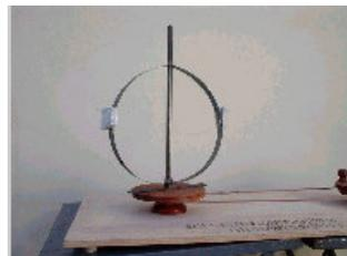
Figura 2: Experimento do aro flexível (achatamento da Terra).
