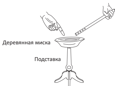
Рис. 11.14: Палец держится у поверхности воды. Когда хорошо потертая стек­лянная трубка удерживалась в пределах 2 или 3 дюймов от пальца, палец дернулся и раздался треск.
