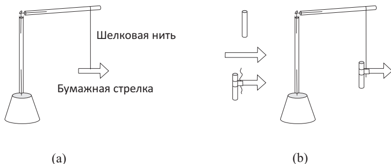
Рис. 2.11: Электрический маятник с подвешенной стрелкой.
