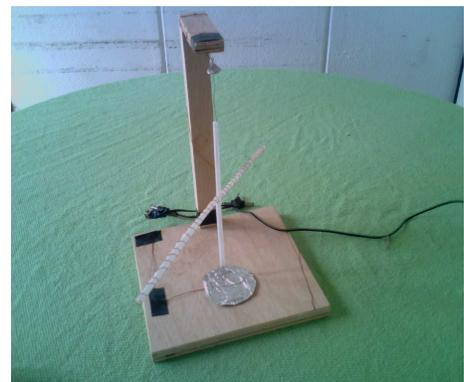
Figura 5: Esboço da experiência da hélice de Ampère. Figura 6: Foto da experiência da hélice de Ampère.
