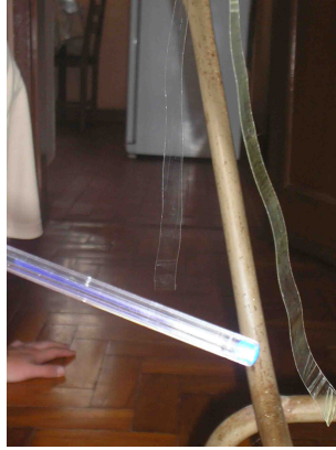
Figura 23: Caneta atritada sendo aproximada de uma fita I. De acordo com Shabay e Sherwood, uma caneta atritada no cabelo ou no algodão fica carregada negativamente. Como esta fita está sendo repelida pela caneta atritada, descobrimos que a fita I fica carregada negativamente.
