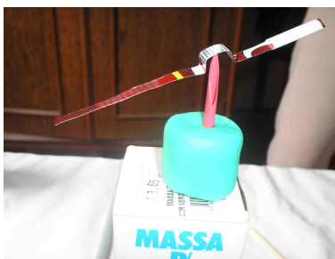
Figura 6: Versorium de alumínio montado sobre uma “agulha” de canudinho de plástico.
