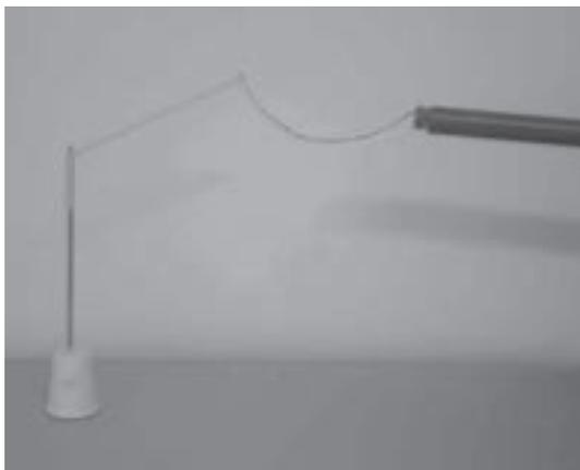
Figura 17.3 – A figura ilustra uma linha pendular de algodão grudada em uma cortiça colocada à extremidade de um tubo de PVC após ser atritado com poliamida. A linha permanece dessa forma por poucos instantes; logo em seguida é repelida pela cortiça.
