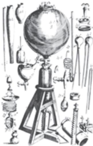
Figura 10.11 – Gravura da bomba de ar desenvolvida por Robert Boyle. A bomba de ar completa é mostrada ao centro, e algumas de suas partes estão ao redor dela Figura extraída de West (2005).
