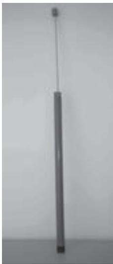
Figura 17.6 – Tubo de PVC com uma rolha de cortiça (A) em sua extremidade, uma vareta de madeira colocada nessa cortiça e uma segunda rolha (B) colocada na extremidade da vareta que está mais afastada do tubo de PVC.
