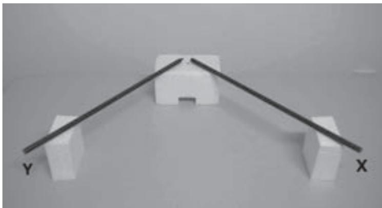
Figura 21.7 – Duas barras metálicas de 50 cm colocadas em forma V sobre bases de isopor.
