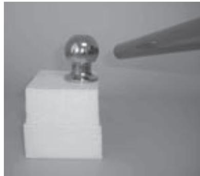
Figura 21.9 – Tubo de PVC atritado sendo aproximado da bola de metal fixada em uma base de isopor.
