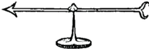
Figura 4.1 – Versório de Gilbert. Figura extraída de Roller e Roller (1957, p.550).
