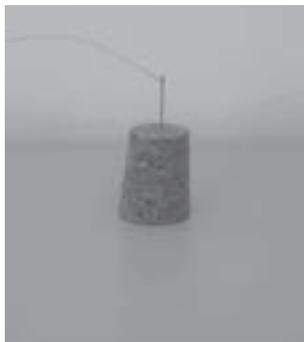
Figura 17.8 – Fio de cobre preso à agulha de costura fincada na rolha de cortiça.
