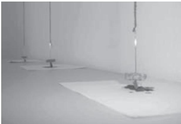
Figura 17.20 – Os três discos de cortiça presos às linhas de algodão por meio de agulhas de costura atraindo pedacinhos de papel de seda colocados sobre um pedaço de papel sulfite, após a eletrização do tubo de PVC por meio de atrito com poliamida.
