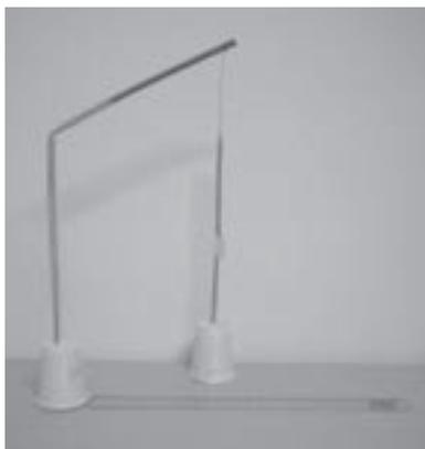
(b) O poste de sustentação ao fundo é referência para verificar quanto o pêndulo se desloca em relação à posição inicial. A régua na figura serve para dar noção de profundidade entre os dois postes.
