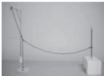
(b) À esquerda, há um suporte de madeira com base de gesso e uma linha de apoio presa a ele na posição vertical. À direita, há um bloco de isopor com um palito de madeira, que são utilizados como suporte para prender a linha de condução, a qual é esticada até o lado esquerdo e fica apoiada na linha de apoio vertical presa ao suporte de madeira. No final da linha de condução, há um disco de cortiça preso a ela por meio de uma agulha de costura.
