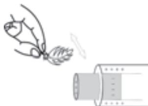
Figura 7.1 – Tubo de vidro arrolhado nas duas extremidades e eletrizado positivamente pelo atrito do vidro contra a mão de Gray. A rolha de cortiça que tampa o vidro não foi atritada, mas comporta-se como um condutor elétrico e ficaria polarizada devido às cargas na superfície do vidro. A ilustração também mostra uma penugem sendo atraída e repelida pela cortiça ao ser mantida defronte à extremidade superior do tubo. Figura adaptada de Assis (2010, p.243).
