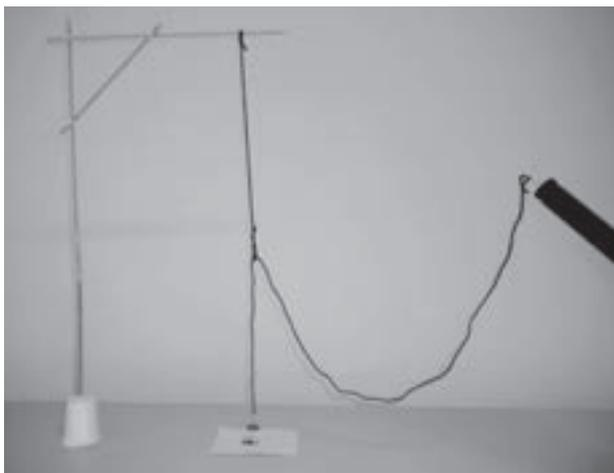
Figura 17.13 – Aparato completo utilizado para experimentos de condução na horizontal. Temos uma linha de sustentação presa ao palito superior e uma linha de transmissão presa ao PVC e com uma cortiça presa em sua outra extremidade.
