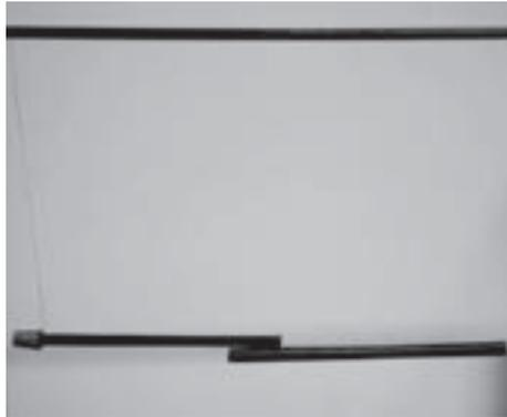
Figura 20.6 – Em detalhe, a figura apresenta duas varetas de madeira na posição horizontal presas à haste horizontal de ferro do suporte de madeira. A vareta da esquerda com uma rolha de cortiça à sua ponta está presa por linha de seda à haste, e a vareta da direita está presa por linhas de poliamida (linhas de pesca).
