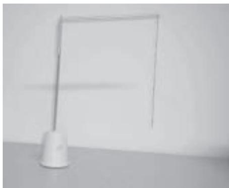
Figura 19.7 – Poste de sustentação com um canudo de plástico colocado em sua extremidade superior em forma  $\Gamma$ . Na extremidade do canudo há uma linha condutora de algodão.
