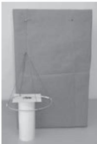
Figura 17.29 – Aro de madeira na posição horizontal preso por quatro linhas de algodão amarradas a uma linha de seda. Essa linha está fixada a um palito de madeira fincado em uma caixa de papelão. A figura também ilustra os pedacinhos de papel de seda utilizados como detectores de eletrização, os quais estão posicionados sob o aro de madeira e sobre uma folha de papel sulfite. Como suporte para os papezinhos de papel de seda foi utilizado um cilindro feito com uma folha de papel sulfite.
