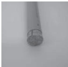
(b) Rolha de cortiça e camada externa de uma rolha encaixadas no tubo de PVC.
