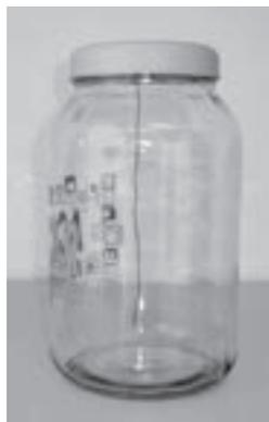
(b) Em detalhe, um recipiente de vidro com uma linha de algodão presa a sua tampa pelo lado de dentro.
