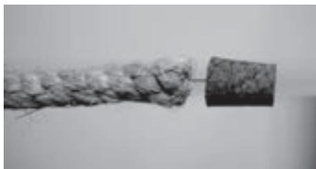
Figura 20.11 – Em detalhe, a figura mostra como foi feita a fixação da rolha de cortiça à corda por meio de uma agulha de costura.
