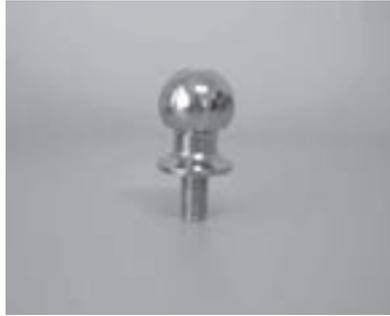
Figura 21.8 – Em detalhe, a bola metálica de 5 cm de diâmetro.
