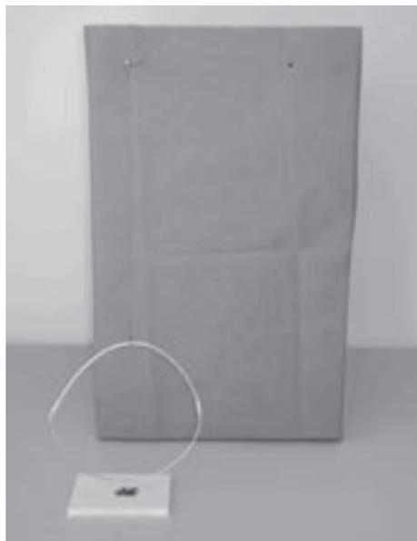
Figura 17.26 – Aro de madeira preso por uma linha de seda a um palito de madeira fixado em uma caixa de papelão. A figura também ilustra os pedacinhos de papel de seda utilizados como detectores de eletrização, os quais estão posicionados sob o aro de madeira e sobre uma folha de papel sulfite.
