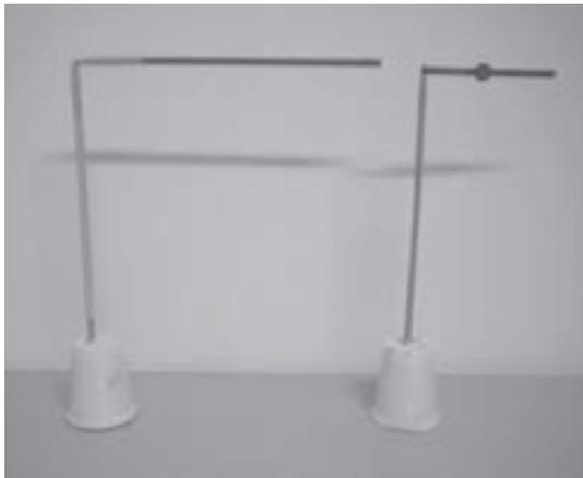
Figura 15.9 – Os dois suportes: à esquerda com canudo de plástico como haste horizontal e à direita com colchete de metal como haste horizontal.
