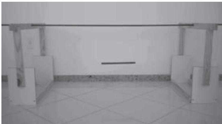
Figura 20.4 – Suporte de madeira com haste horizontal de ferro e uma vara de madeira pendurada por meio de linhas de poliamida.
