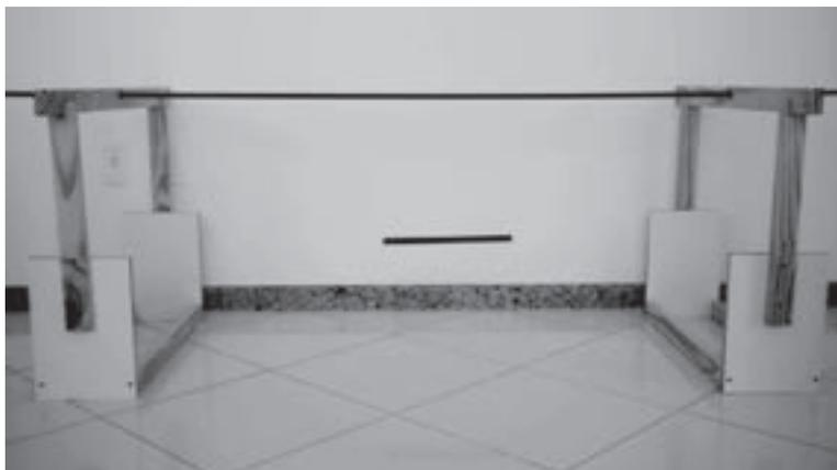
Figura 22.1 – Suporte de madeira com haste horizontal de ferro e uma vara de madeira pendurada por meio de linhas de poliamida.
