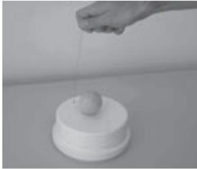
Figura 23.1 – No alto da figura, uma mão segura a linha de seda, em cuja extremidade inferior está presa uma bolinha de cortiça. A cortiça gira, no plano equatorial, ao redor de uma esfera eletrizada de madeira colocada sobre uma base de PVC atritada.
