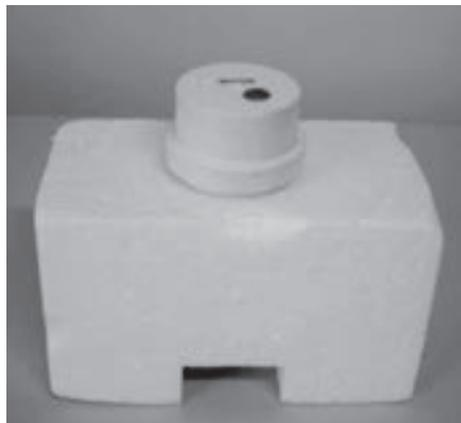
Figura 18.8 – Sobre uma mesa de madeira há um bloco de isopor, uma peça de PVC está posicionada sobre o isopor, e a porção de água está sobre a peça de PVC.
