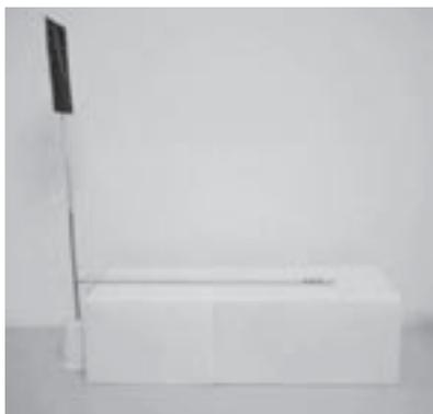
(a) À esquerda, temos um eletroscópio, ao centro há um apoio para a régua (nesse caso, utilizamos uma caixa de sapato) e uma régua de 30 cm apoiada sobre a caixa.
