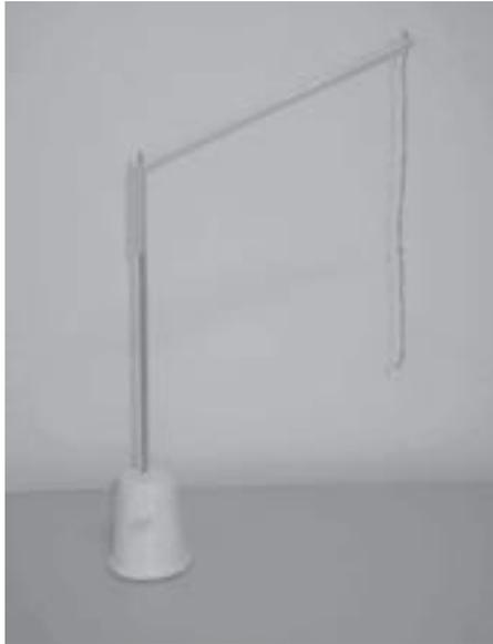
Figura 17.2 – Linha pendular de algodão presa a um suporte por meio de um canudo.
