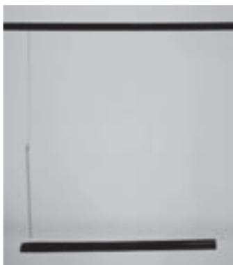
Figura 20.5 – Em detalhe, a figura apresenta a vareta de madeira horizontal presa por linhas de poliamida (linhas de pesca) na haste horizontal de ferro do suporte de madeira e a vareta vertical presa por linha de seda à mesma haste.
