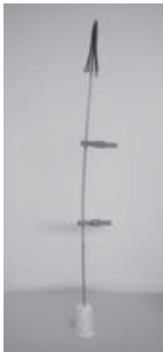
Figura 15.13 – Ilustração do aparato isolado com canudo de plástico. Na parte inferior, temos um poste de sustentação, ao meio temos um canudo de plástico, na parte superior um instrumento elétrico. Os dois prendedores de roupa marcam a posição em que estão as extremidades dos palitos de madeira inseridos no canudo. Observe a distância que há entre a extremidade de cada palito dentro do canudo.
