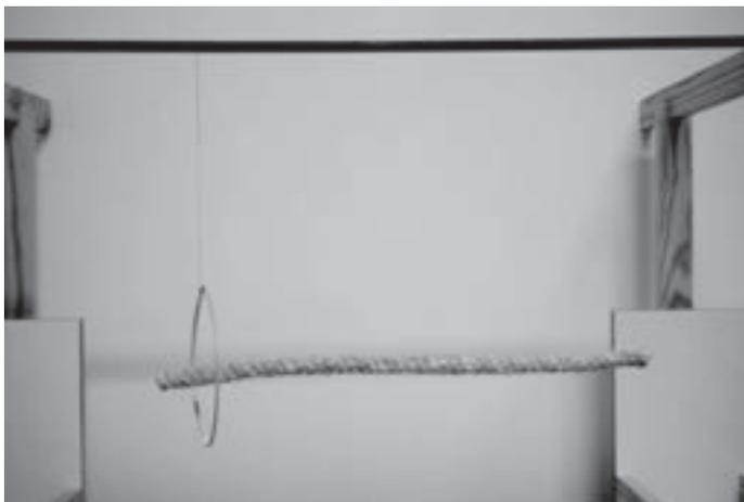
Figura 20.8 – A figura apresenta um aro de madeira e um pedaço de corda suspensos na haste horizontal de ferro do suporte de madeira. O aro de madeira está preso por linha de seda à haste, e a corda está presa por linhas de poliamida (linhas de pesca).
