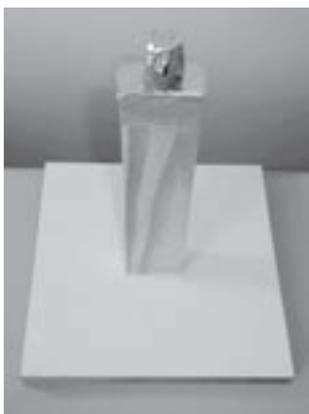
Figura 18.3 – Suporte de madeira (base + haste vertical) com a extremidade superior envolta por papel-alumínio, uma rolha de cortiça também envolta com papel-alumínio sobre a haste vertical e uma gota de água colocada sobre o papel-alumínio da rolha.
