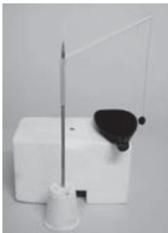
Figura 18.4 – Sobre a base de isopor está posicionada uma colher de madeira sem cabo; dentro da colher há uma certa quantidade de água. A figura também mostra um pêndulo elétrico. Isto é, um suporte com base de gesso, fixado a ele há um canudinho de refresco como haste horizontal no qual está presa uma linha de seda com um disquinho de papel de seda na ponta inferior.
