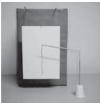
(a) Folha de papel sulfite (A4) presa por linhas de algodão a palitos de madeira que estão fixados em uma caixa de papelão. A figura também ilustra a linha pendular utilizada como detector de eletrização. Foto frontal do aparato.
