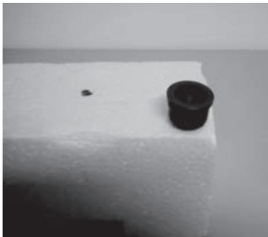
Figura 18.7 – Recipiente de PVC (CAP de 2 cm de diâmetro interno) cheio de água e sobre uma base de isopor.
