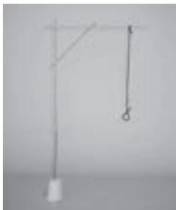
Figura 17.12 – Aparato utilizado para sustentar o fio condutor, feito com suporte com base de gesso, palitos de madeira e linha de algodão.
