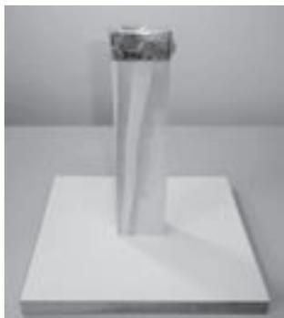
Figura 18.2 – Suporte de madeira (base + haste vertical) com a extremidade superior envolta por papel-alumínio e uma grande gota de água colocada sobre o papel-alumínio.
