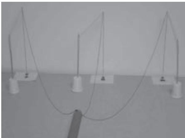
Figura 17.19 – Aparato utilizado para o experimento em “que a virtude elétrica é transportada ao mesmo tempo por vários caminhos”. Três pedaços de linha de algodão são presos a um tubo de PVC, seguem horizontalmente até um suporte isolante e, então, seguem verticalmente até próximo à superfície. Nessa extremidade de cada linha condutora há um disco de cortiça preso a elas por meio de uma agulha, abaixo dos discos há pedacinhos de papel de seda colocados sobre um pedaço de papel sulfite.
