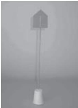
(a) A figura apresenta o instrumento elétrico em forma de “casinha” com haste metálica na extremidade superior, tirinha de papel de seda ao centro e canudinho de refresco preso a um suporte com base de gesso.
