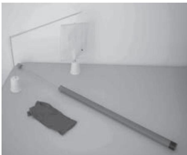
Figura 17.7 – A figura mostra o tubo de PVC com uma rolha (A), vareta de madeira e a segunda rolha (B); o material de poliamida utilizado para a eletrização do tubo; e os instrumentos para verificação da eletrização, isto é, anteparo de papel sulfite aterrado e disco de papel de seda preso em uma linha de seda fixada em um suporte.
