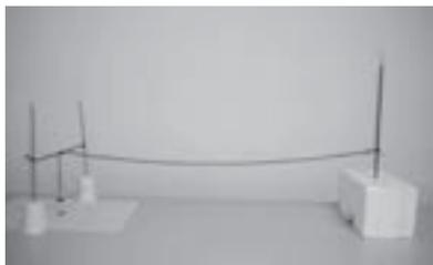
(a) À esquerda, há dois suportes com base de gesso e uma linha de apoio presa entre eles na posição horizontal. À direita, há um bloco de isopor com um palito de madeira, que são utilizados como suporte para prender a linha de condução, a qual é esticada até o lado esquerdo e fica apoiada na linha de apoio horizontal entre os suportes com base de gesso. No final da linha de condução, há um disco de cortiça preso a ela por meio de uma agulha de costura.
