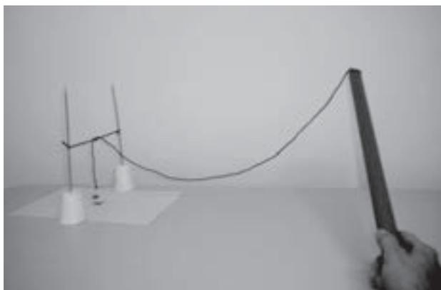
Figura 17.16 – Aparato completo utilizado para o experimento com o qual se ilustra a maneira como Gray e Wheler chegaram à condução da eletricidade com o fio condutor disposto na posição horizontal. À esquerda, há dois suportes com base de gesso e
