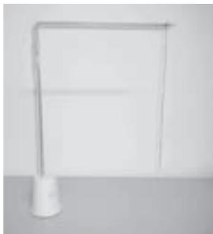
(a) Poste de sustentação com um palito de madeira colocado na ponta em forma  $\Gamma$ . Na extremidade do segundo palito tem uma linha de algodão.
