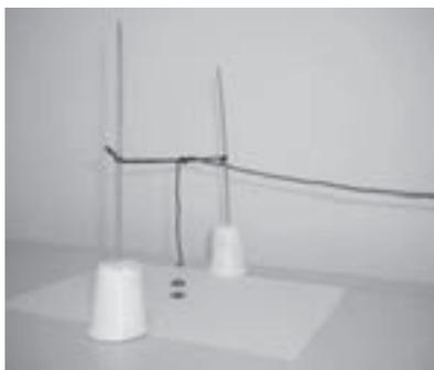
(b) Na vertical está a linha de transmissão, presa a um disco de cortiça por meio de uma agulha, que está apoiada na linha de apoio horizontal colocada entre os suportes com base de gesso e segue horizontalmente até o tubo.
