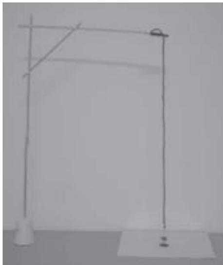
Figura 17.21 – Aparato completo utilizado para o experimento em que há transporte de eletricidade sem que o tubo toque a linha de transmissão. Há um suporte de madeira feito com palitos de churrasco e base de gesso, uma linha de seda pendurada verticalmente ao suporte por meio de uma garra “tipo boca de jacaré” e, preso à extremidade inferior da linha, um disco de cortiça fixado por meio de uma agulha.
