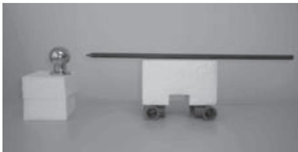
Figura 21.10 – À esquerda está a bola metálica sobre uma base de isopor, e à direita uma barra de ferro sobre uma base de isopor. Embaixo da base de isopor que suporta a barra metálica há algumas peças de PVC apenas para ajustar a altura da barra.
