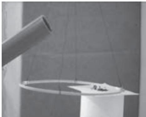
Figura 17.30 – O aro de madeira preso a quatro linhas de seda atraindo pedacinhos de papel de seda colocados sobre um pedaço de papel sulfite, após eletrizar o tubo de PVC por meio de atrito com poliamida e aproximá-lo do aro.
