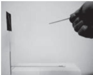
(b) Medida sendo realizada. À direita, o canudo segurado com a mão é aproximado do eletroscópio.
