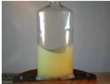
Fig. 2 – Balde de Newton em rotação na filmagem final.
