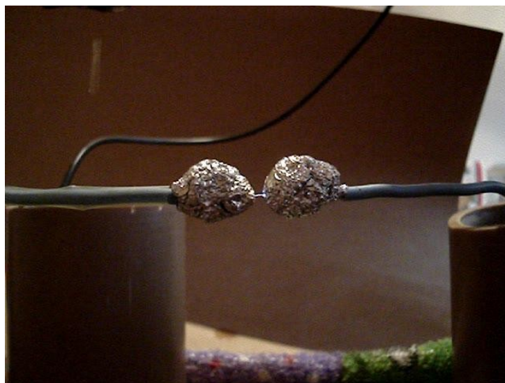
Fig. 21: Faísca gerada entre as duas esferas de alumínio.
