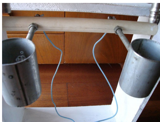
Fig. 13: Indutores isolados da madeira com PVC.
