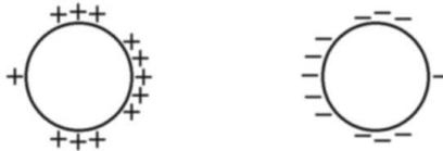
Abbildung 8.4: Qualitative Verteilung von Oberflächenladungen für zwei parallele Leiter in der Ebene  $z = 0$ .
