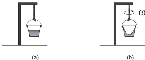
Figura 8.10: (a) Balde e água em repouso em relação ao solo, com a superfície da água horizontal. (b) Balde e água girando juntos com uma velocidade angular constante  $\omega$  em relação ao solo. Observa-se que a superfície da água fica côncava, tendo abaixado ao longo do eixo de rotação e subido pelas paredes do balde.
