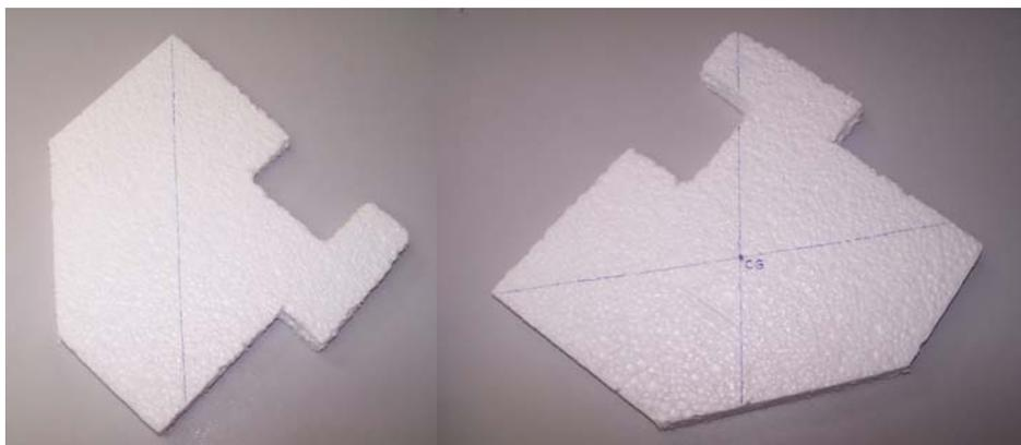
Fig 4. Determinação do C.G. de uma figura plana
