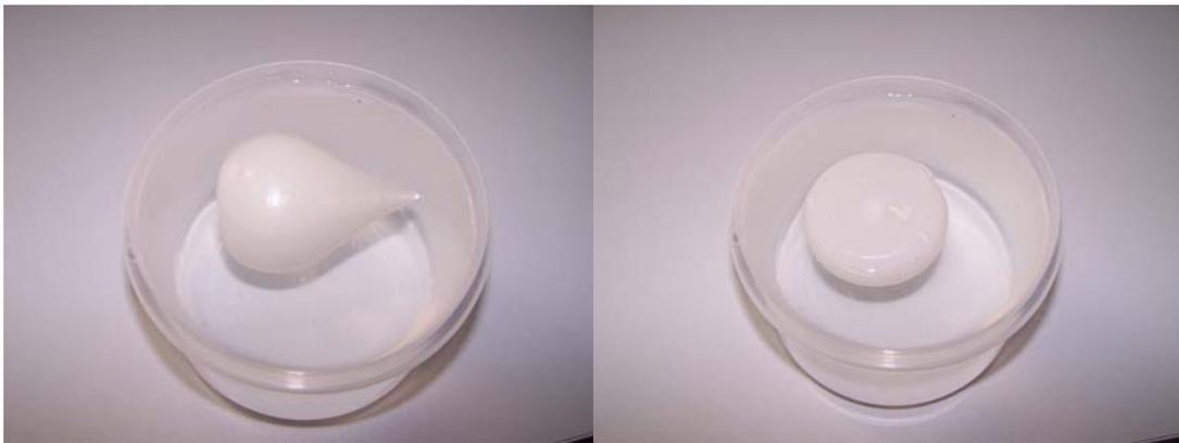
Fig 6. Duas posições possíveis de equilíbrio estável para um sólido em forma de gota.
