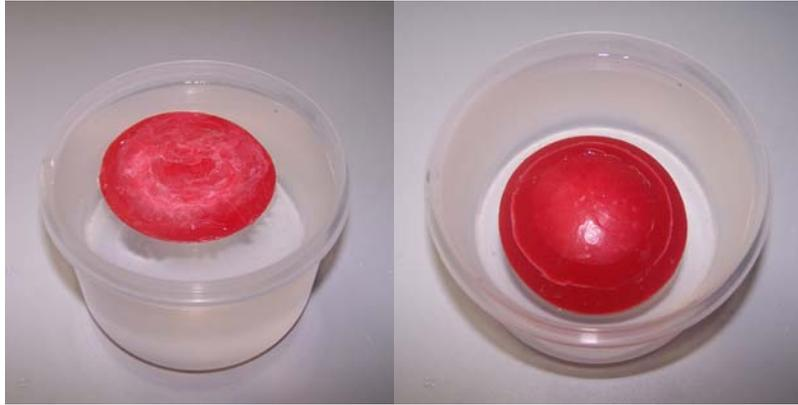
Fig 8. Duas posições possíveis de equilíbrio estável para um parabolóide de revolução raso. O equilíbrio só é possível com o eixo na vertical.
