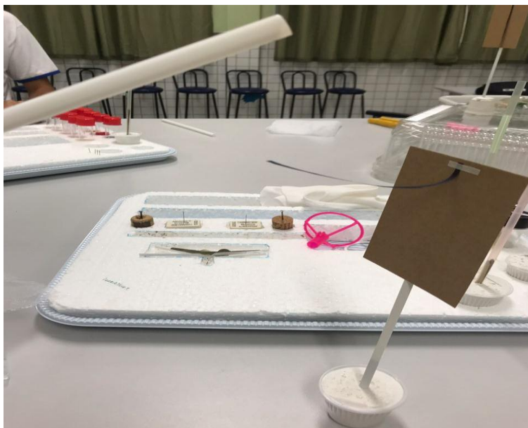
Figura 21. Eletroscópio carregado por indução.
