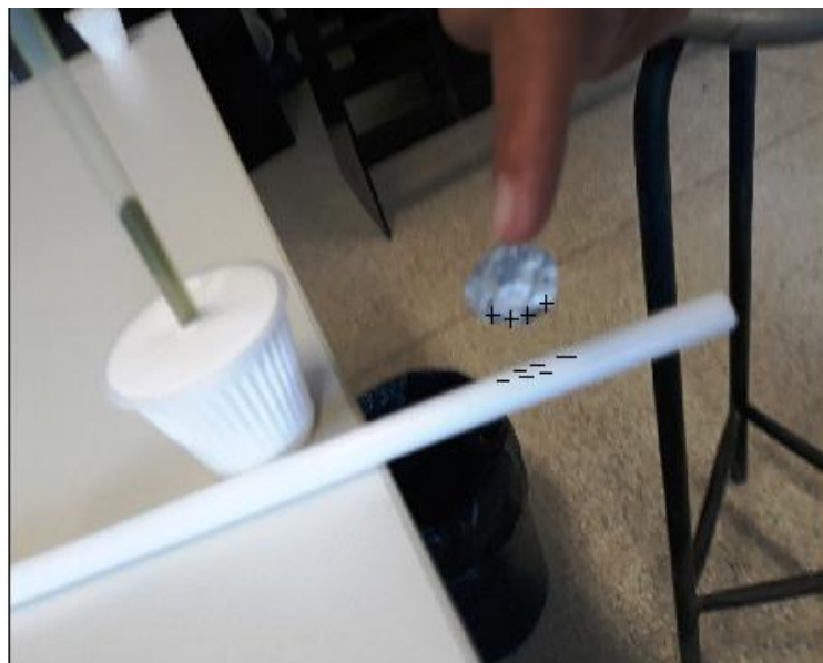
Figura 16. Aterramento do disco de papel alumínio dando condições das cargas negativas escaparem.
