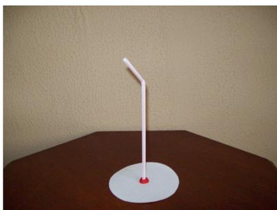
Figura 4: O eletróforo de Volta.
