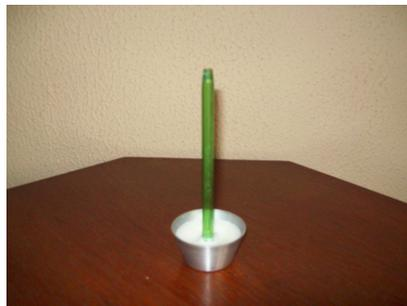
Figura 6: Concha com o eletreto espetado por um cabo isolante, tomando a forma de um “picolé”.
