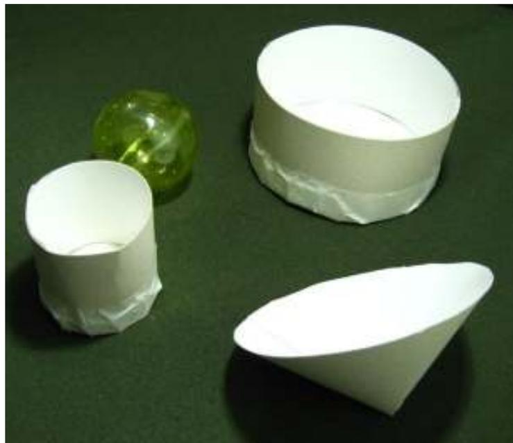
Figura 31: Moldes prontos para a aplicação do gesso.
