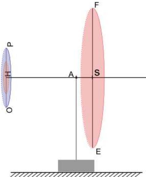
Figura 13.1: Representação tridimensional da alavanca em equilíbrio.
