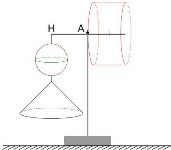
Figura 14: Alavanca em equilíbrio ao redor do fulcro A com a esfera ABCD e o cone AEF dependurados em H, enquanto que o cilindro LGFE está dependurado ao redor do braço AKC.
