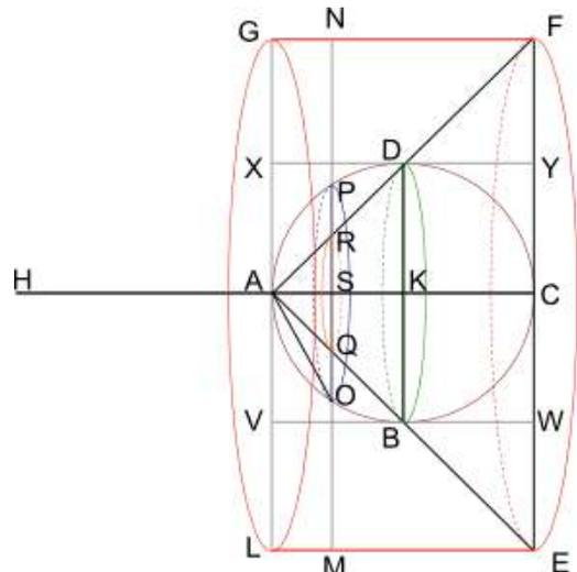
Figura 12.2: O plano ortogonal ao segmento HAAC e passando por MN vai cortar o cone, a esfera e o grande cilindro em três círculos de raios crescentes.
