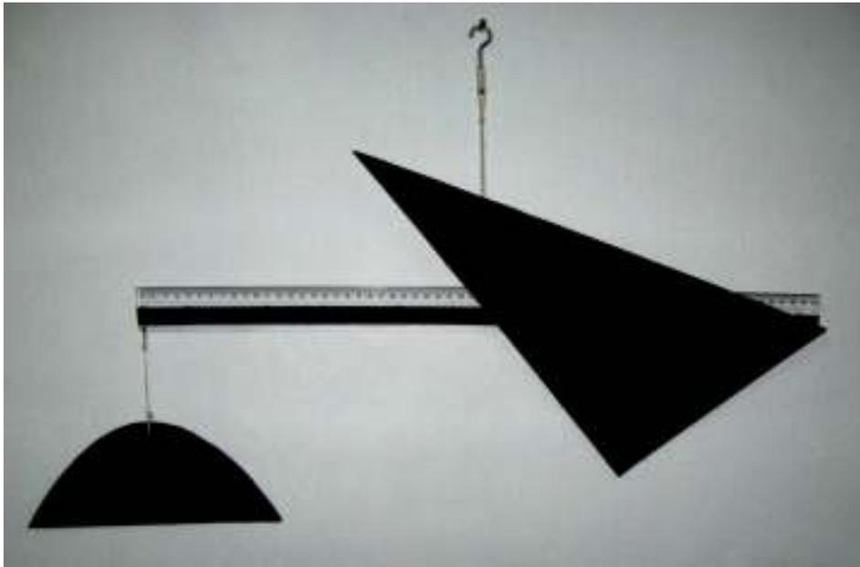
Figura 25: Alavanca equilibrada com a parábola e o triângulo.
