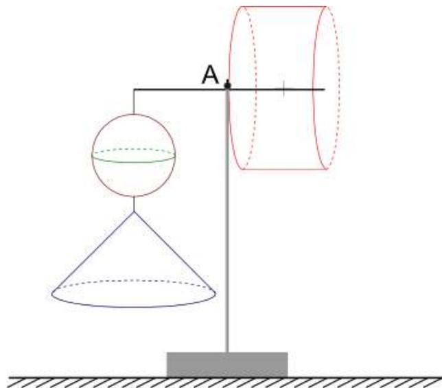
Figura 35: Alavanca em equilíbrio com a esfera, o cone e o cilindro grande (situação teórica).
