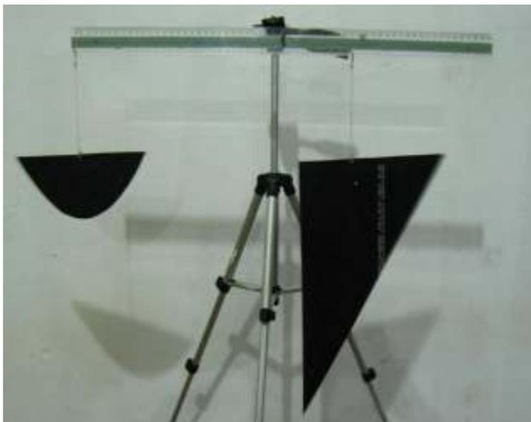
Figura 28: Alavanca em equilíbrio com a parábola dependurada de um lado e o triângulo grande do outro lado.
