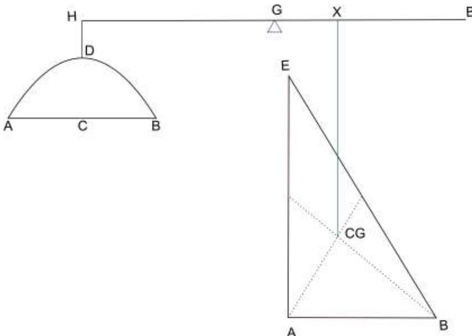
Figura 9: Alavanca em equilíbrio com a parábola ADB dependurada em H, enquanto que o triângulo AEB está dependurado por um ponto X tal que  $GX = 2XB$ .
