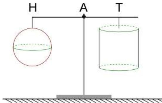
Figura 16: Alavanca em equilíbrio com uma esfera e o cilindro circunscrito a esta esfera.
