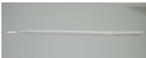
Figura 118: Tirinha de papel alumínio presa a um canudinho de refresco.
