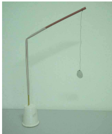
Figura 9: Ilustração de um pêndulo completo. Neste caso, feito com um disco de papel alumínio.
