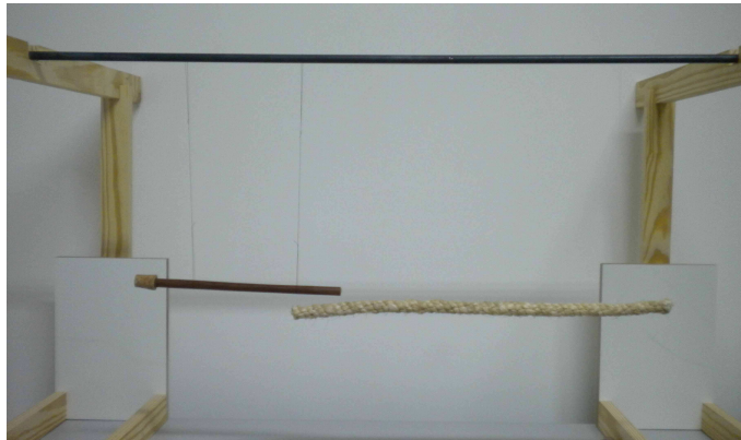
Figura 169: A figura apresenta uma vareta de madeira com uma rolha de cortiça à sua ponta e um pedaço de corda, ambos na posição horizontal, suspensos pela haste horizontal de ferro do suporte de madeira. A vareta de madeira está presa por linhas de seda à haste e a corda está presa por linhas de poliamida (linhas de pesca).
