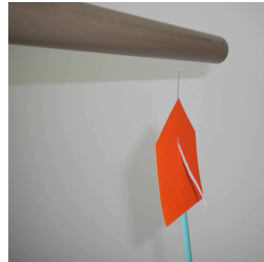
(b) Tubo de PVC próximo à ponta da haste metálica e a tira de papel de seda levantada devido à ação do tubo.
