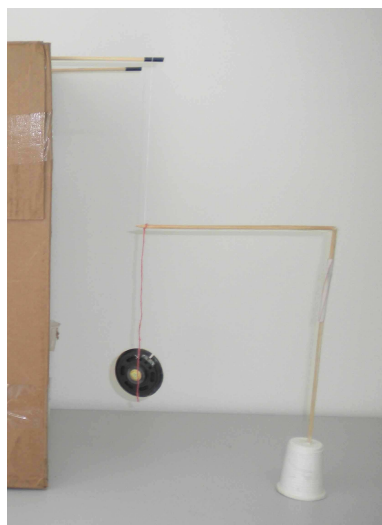
(a) Ímã preso por uma linha de algodão a um palito de madeira que está fixado em uma caixa de papelão. A figura também ilustra a linha pendular utilizada como detector de eletrização.
