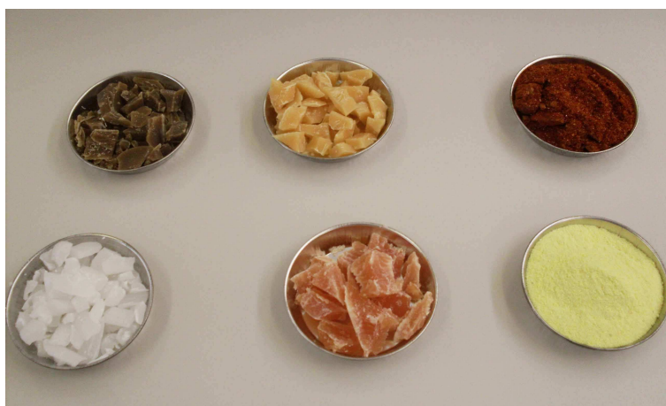
Figura 123: As seis substâncias utilizadas. Na fileira superior da esquerda para a direita: cera de carnaúba escura, cera de carnaúba clara e goma-laca. Na fileira inferior da esquerda para a direita: parafina, cera de abelha e enxofre. Estão dentro dos recipientes de flandre antes de serem derretidas.
