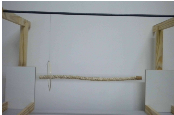
Figura 172: A figura apresenta um pedaço de corda com rolha de cortiça preso por linhas de poliamida (linhas de pesca) à haste horizontal de ferro do suporte de madeira e um aro de madeira preso a mesma haste por linha de seda e posicionado na extremidade da corda oposta àquela em que está a cortiça.
