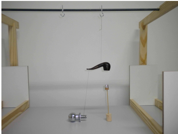
Figura 108: Cachimbo suspenso por linhas de seda, abaixo do forninho há uma rolha de cortiça presa a um palito e pequena base de madeira.
