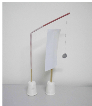
(b) Pêndulo elétrico com uma folha de papel sulfite aterrada colocada atrás do disco de papel alumínio.
