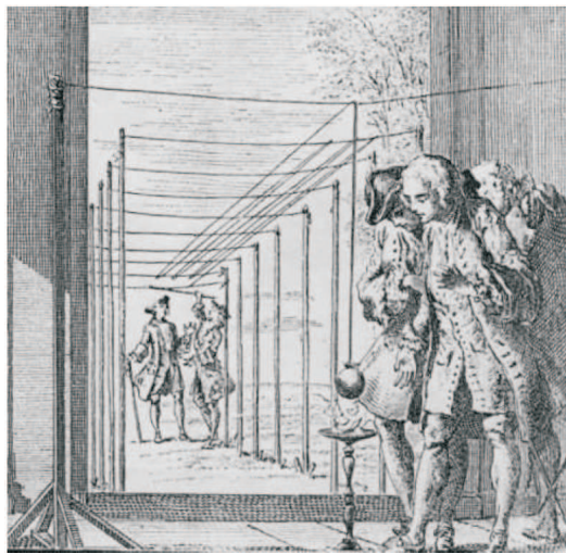
Figura 61: A linha de comunicação, feita de um material condutor, com vários retornos e apoiada sobre fios de material isolante (GAUDENZI; SATOLLI, 1989; BLONDEL; WOLFF, 2005). Em uma das extremidades da linha de comunicação há uma bola atraindo corpos leves e nas proximidades da outra extremidade há alguém segurando o tubo eletrizado.
