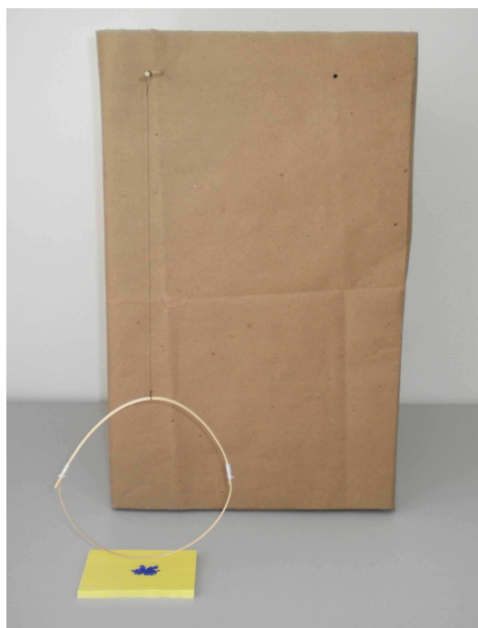
Figura 99: Aro de madeira preso por uma linha de seda a um palito de madeira fixado em uma caixa de papelão. A figura também ilustra os pedacinhos de papel de seda utilizados como detectores de eletrização, os quais estão posicionados sob o aro de madeira e sobre uma folha de papel sulfite.
