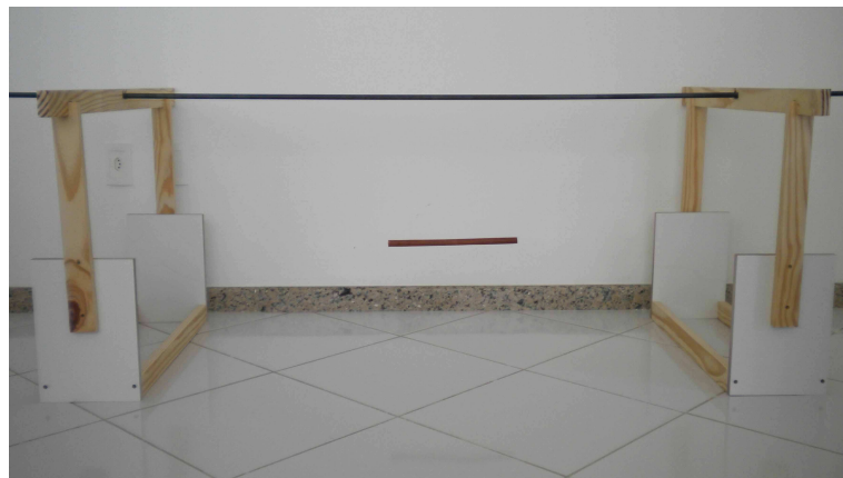
Figura 203: Suporte de madeira com haste horizontal de ferro e uma vara de madeira pendurada por meio de linhas de poliamida.
