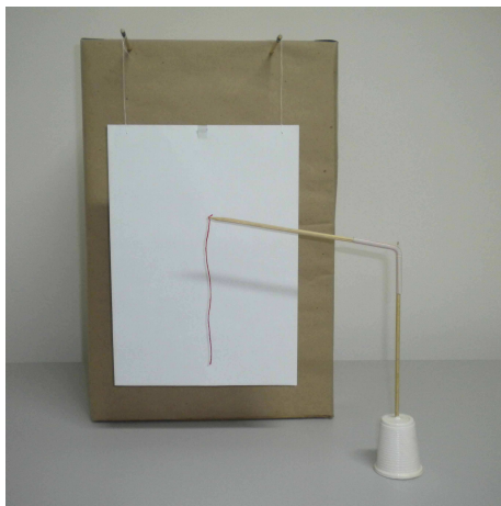
(a) Folha de papel sulfite (A4) presa por linhas de algodão a palitos de madeira que estão fixados em uma caixa de papelão. A figura também ilustra a linha pendular utilizada como detector de eletrização. Foto frontal do aparato.
