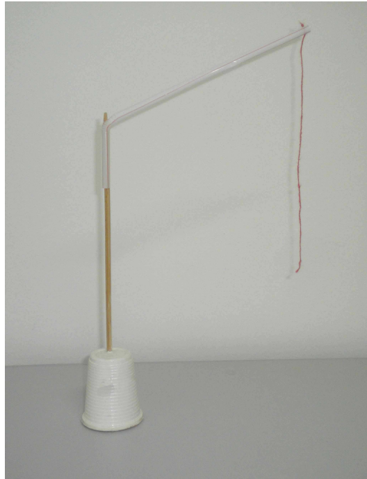
Figura 75: Linha pendular de algodão presa a um suporte por meio de um canudo.
