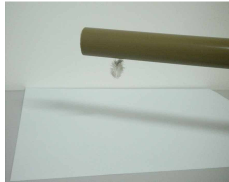
(b) Penugem oscilando entre o tubo de PVC atritado e papel sulfite.
