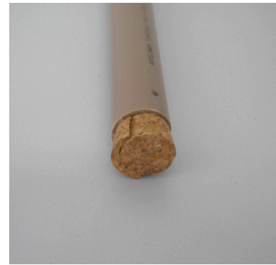
(b) A rolha de cortiça e a camada externa de uma rolha encaixadas no tubo de PVC.
