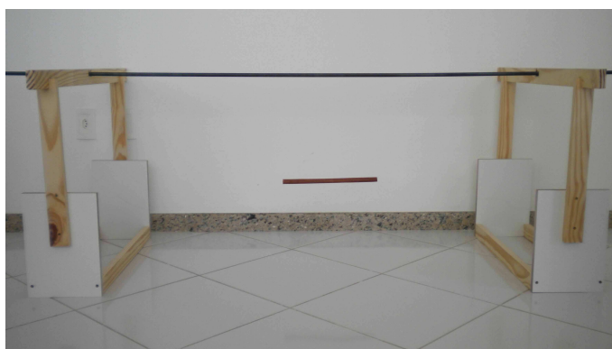
Figura 166: Suporte de madeira com haste horizontal de ferro e uma vara de madeira pendurada por meio de linhas de poliamida.
