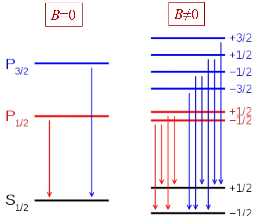
A transição  $2p \rightarrow 1s$  do átomo de hidrogênio na presença de campo magnético (fora de escala).
