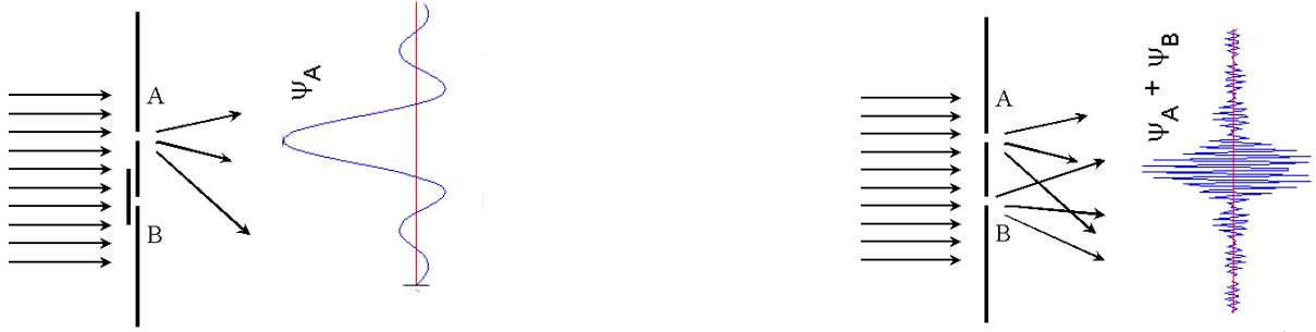
Figura 7.9: Interferência de elétrons no experimento das Fendas de Young, mostrando a densidade de probabilidade |\psi|^2 em função da posição sobre o anteparo depois das fendas: À esquerda, com uma só fenda; à direita, com as duas fendas abertas.
