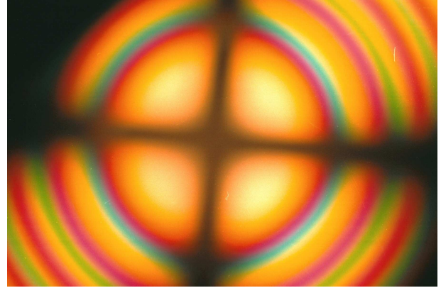
Figura 3.2: Figura de interferência produzida por um cristal de niobato de lítio com o eixo perpendicular ao plano da figura, observado com luz branca convergente, entre polarizadores cruzados
