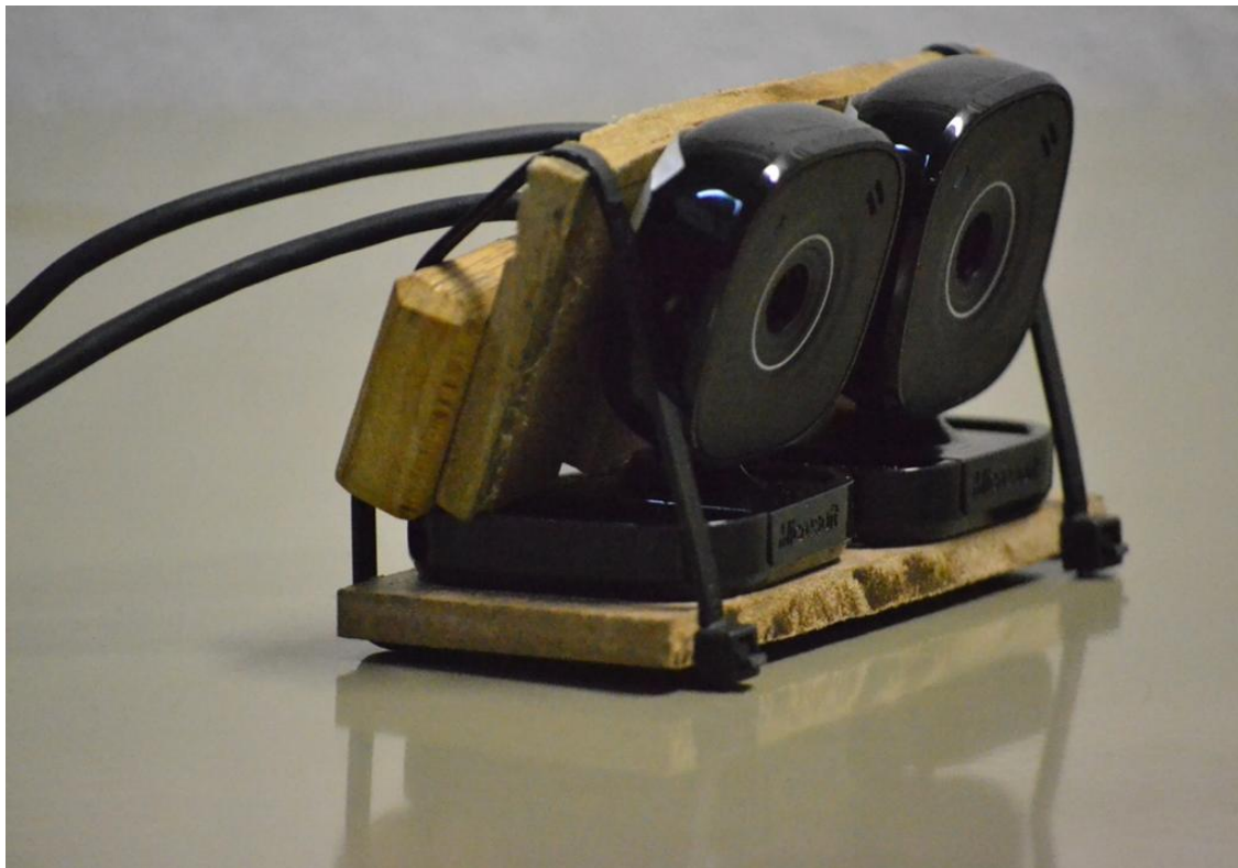
Foto 3: Câmera 3D montada a partir de câmeras web de alta definição
