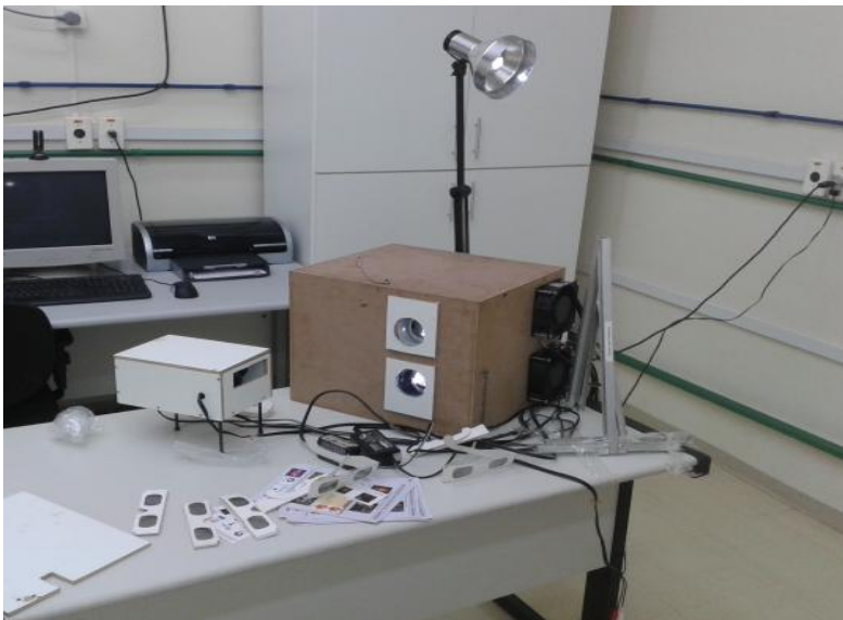
Foto 1: Caixa da câmera dupla apontando na direção de iluminação e, a direita, a caixa do projetor duplo. Na mesma mesa, tradicionais óculos em cartolina polarizados linearmente.
