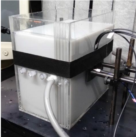
Figura 8: Foto da amostra utilizada para caracterização do equipamento. A caixa possui dimensões 250x250x150 mm.
