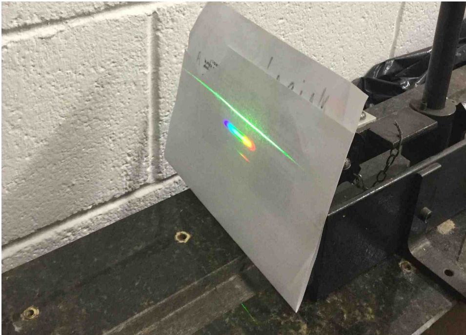
Figura 15 - Registro do espectro da lâmpada halógena
