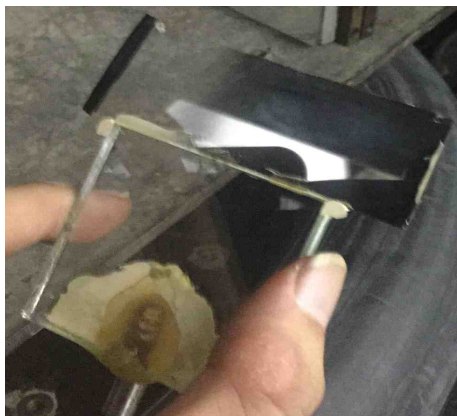
Figura 5: Semi-espelho de refletividade variável
