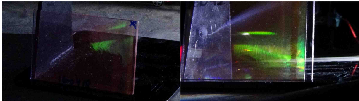
Figura 3: Holograma mostrando defeitos nas placas LitiHolo
