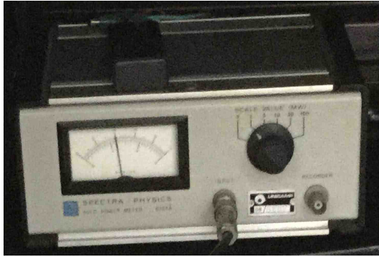
Figura 8: Aparelho que mede a potência do feixe de luz incidente (fora de campo a cabeça do detetor).
