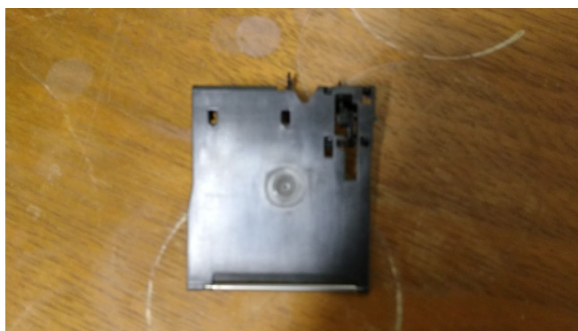
Figura 6: Porta de barragem para exposição da fonte radioativa de Am-241.
