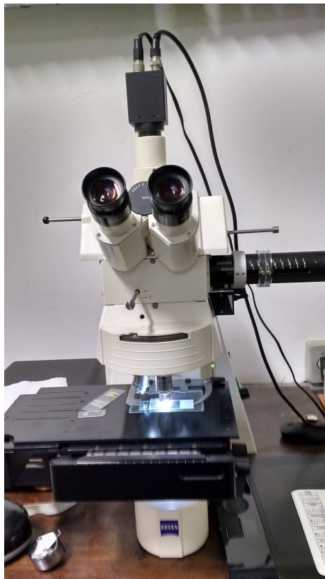
Figura 10:Microscópio Óptico com câmera CCD acoplada em sua parte superior
