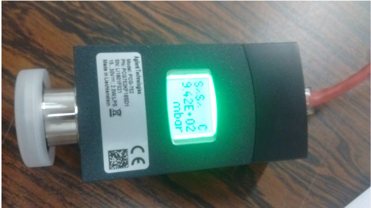
FIGURA-6: Medida da pressão realizada sem o divisor de tensão.
