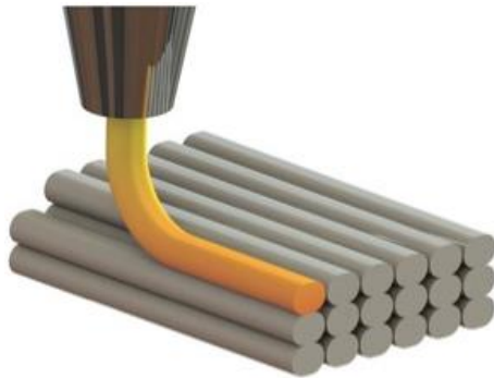
Figura 3 – Ilustração da confecção de peças por camada (4) .
