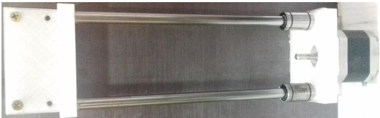
Figura 12 – Eixos lisos já colocados nos suportes das extremidades com auxílio de uma morsa para melhor alinhamento.
