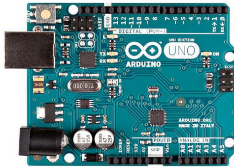
Figura 4 – Visualização do hardware do Arduino UNO (6) .
