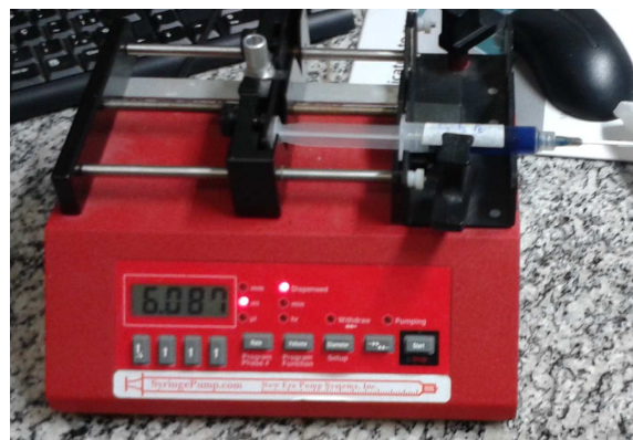
Figura 3 - Bomba de seringa microfluídica NE-4002X New Era Pump Systems
