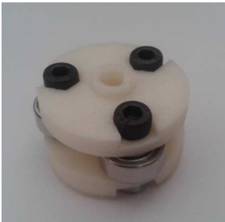
Figura 9 – Conjunto formado pelas peças rotor superior e rotor inferior com os rolamentos.
