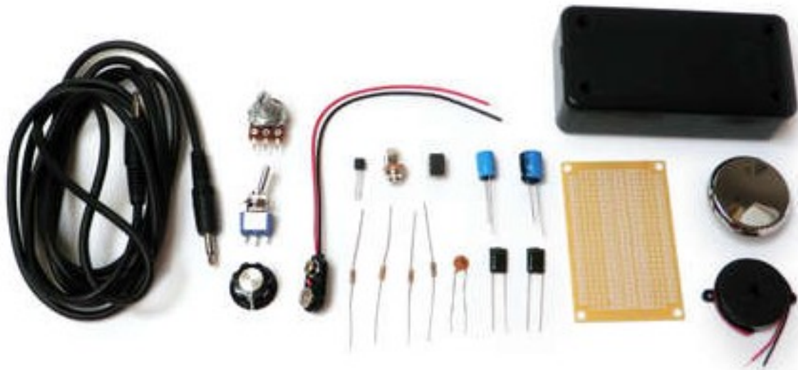
Figura 1: Componentes para confecção do estetoscópio eletrônico
