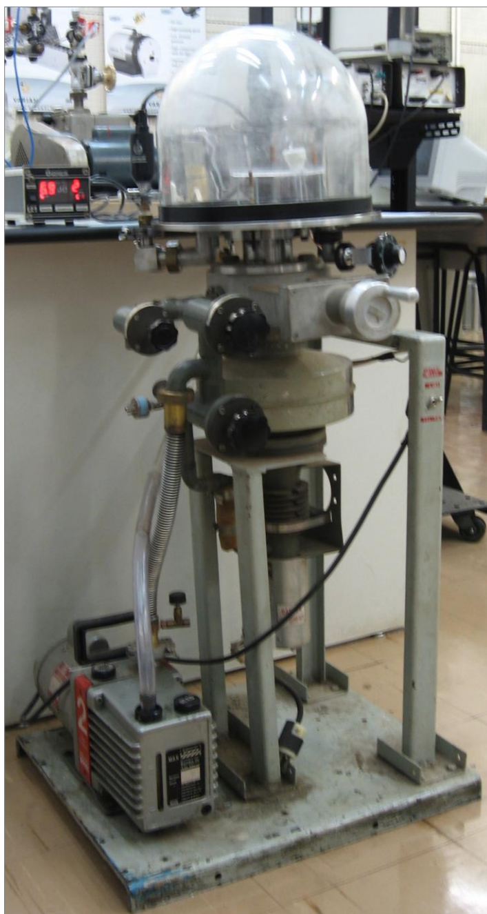
Figura 2: Equipamento do Laboratório de Vácuo do IFGW/Uncamp utilizado para os testes referentes à análise de intensidade de vácuo necessária para que as partículas \alpha provenientes da fonte radioativa de ^{226}\text{Ra} cheguem até os detectores PADC (posicionados a 7 cm da fonte).
