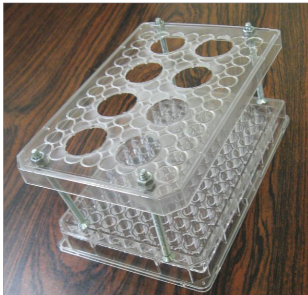
Figura 2: Arranjo experimental para irradiação dentro da câmara de vácuo com a placa de 96 clusters . A fonte radioativa de ^{226}\text{Ra} é encaixada nos buracos da tampa.
