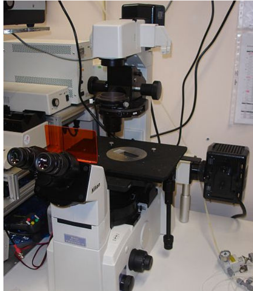
Figura 1: microscópio óptico invertido com estágio porta amostra manual, do mesmo modelo utilizado no laboratório SPM do DFA [5].
