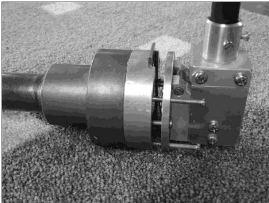
Figura 4. Adaptação do dispositivo mecânico ao colimador de raios-X.
