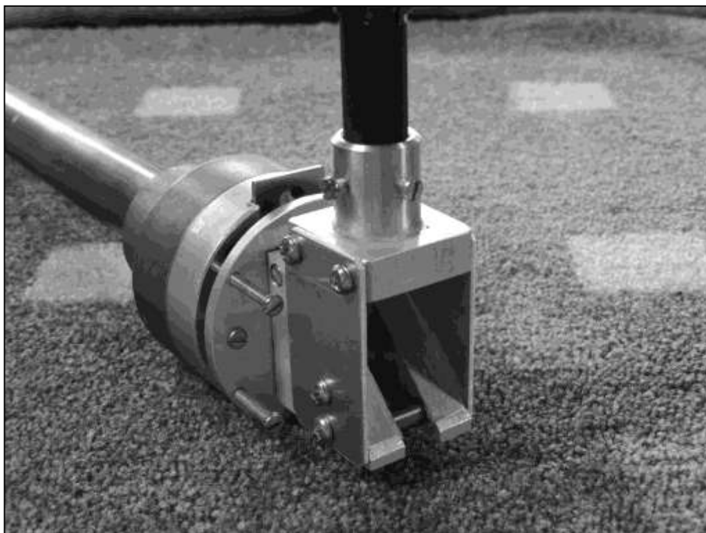
Figura 9: Dispositivo mecânico para o pré-alinhamento do feixe de raios-X para experiências com essa radiação.
