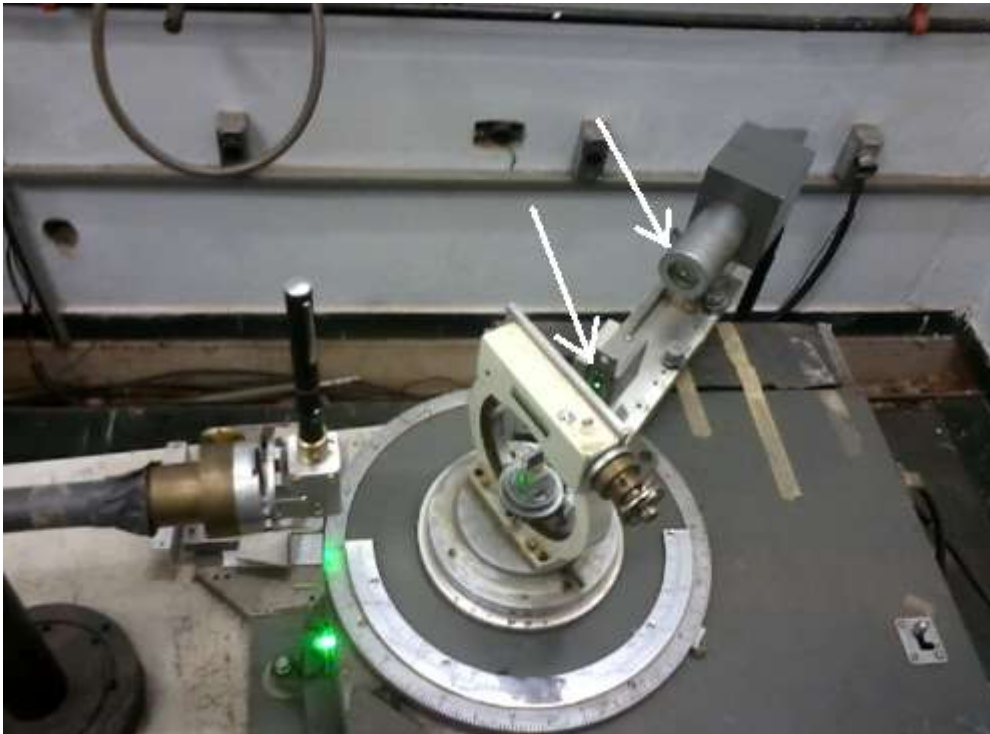
Figura 10: Resultado da montagem do dispositivo no colimador já na geometria para as experiências de difração de raios-X com monocristais. Vê-se a amostra fixa no goniostato de círculo completo e a indicação do caminho do feixe de laser passando pela fenda e incidindo no detector.
