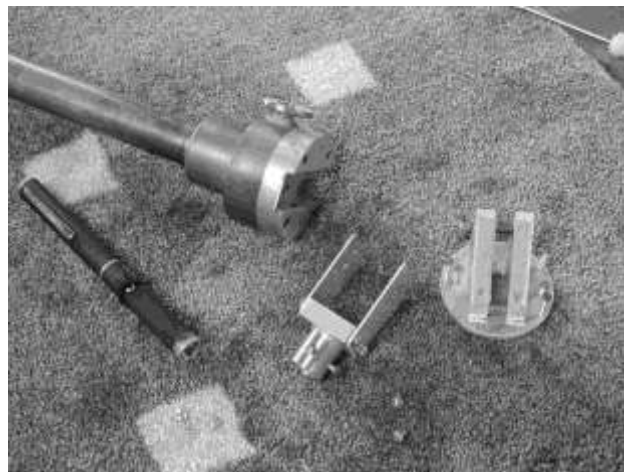
Figura 2. Peças de alumínio do dispositivo para alinhamento do feixe de raios-X incidentes mostradas separadamente, para melhor visualização.
