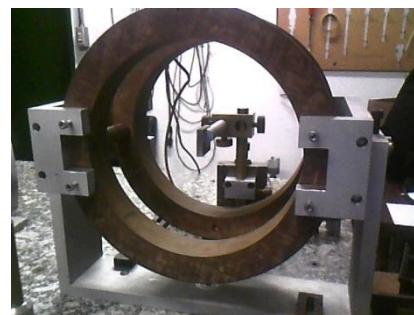
Figura 3.5b Bobina na posição longitudinal.
