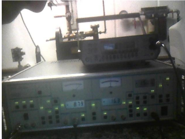
Figura 3.6 Lock-in (abaixo) e multímetro (acima).
