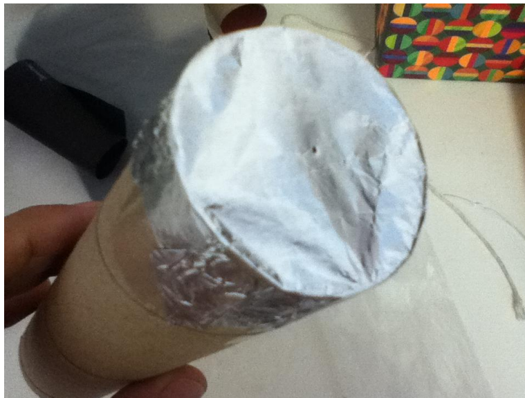
Figura 5: Furo no papel alumínio envolvido em um extremo do tubo para entrada da luz
