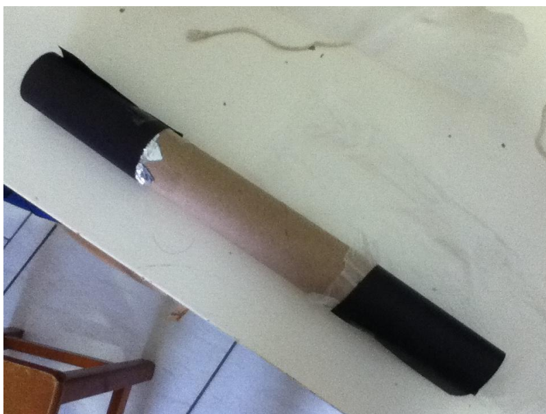
Figura 7: Câmara montada. Os rolos em preto foram feitos com papel cartão para limitar a entrada de luz nas extremidades.
