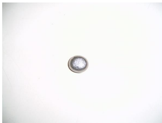
Figura 4 - Foto de um "botão" fundido de TbAl 2
