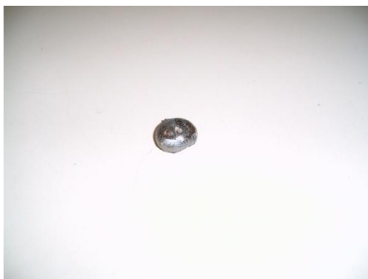
Figura 3 - Foto de um "botão" fundido de TbB 2
