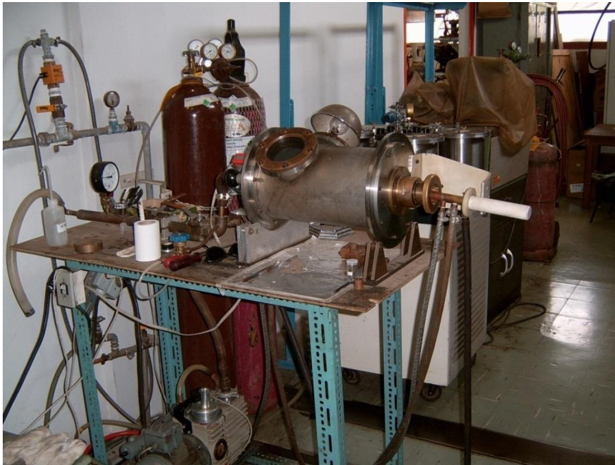
Figura 2 - Sistema com forno à arco, bomba de vácuo e tubo de argônio
