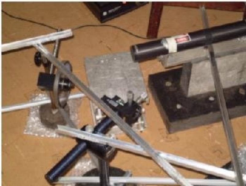
Figura 4: Detalhe de sistema da estabilização mecânica 2 – barras de Al superiores e inferiores
