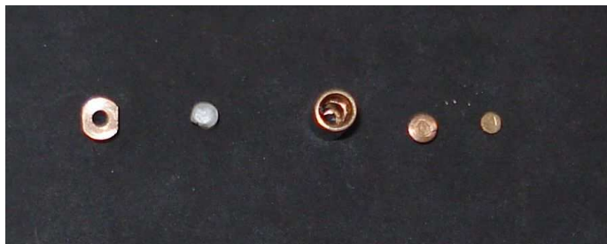
Fig. 7: Visão de cima dos componentes: Parafuso, cápsula de teflon (tem uma pequena deformação, pois já foi utilizada), cilindro principal (é possível ver o pequeno furo na parte inferior do interior do cilindro), pistão e moeda de apoio.
