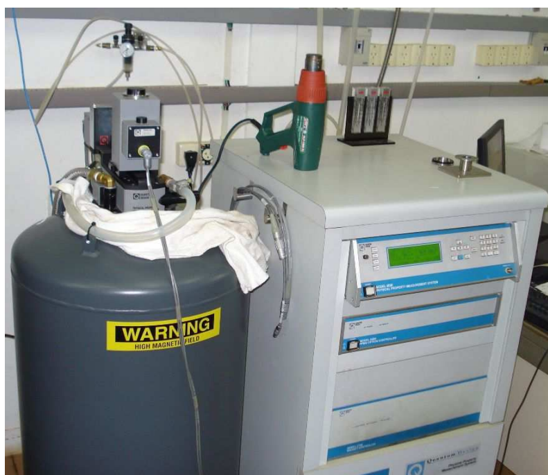
Fig. 3: Visão Geral do PPMS no laboratório: O Cilindro a esquerda é um Dewar com Helio líquido, dentro do qual vai o outro cilindro, mostrado na figura anterior. À direita está o controlador do PPMS, que é o computador central que faz todos os cálculos
