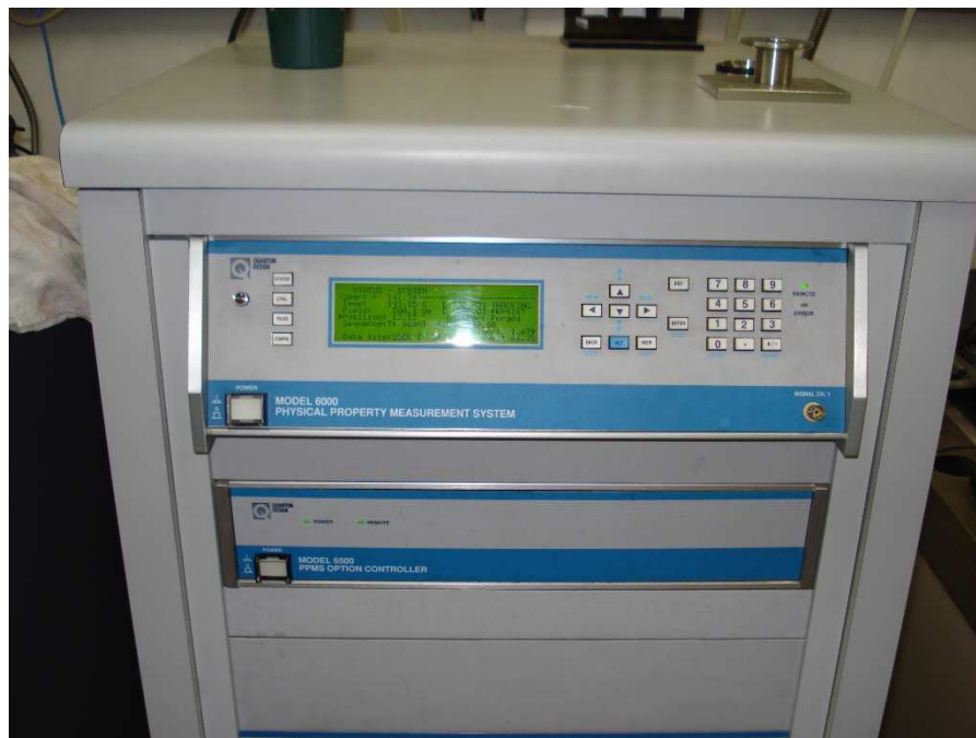
Fig. 5: Destaque na central do PPMS. É aqui, neste computador, que são feitos os cálculos e é por onde são controlados todos os dados da amostra, como temperatura, campo, posição, etc. É possível também monitorar o nível de hélio no Dewar, e a rotina que o equipamento está realizando.
