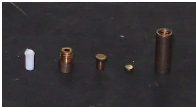
Fig. 6: Componentes da célula de pressão em perspectiva. Da esquerda para direita: Cápsula de Teflon, parafuso, pistão, "moeda" de apoio (feita de CuBe, serve para evitar que a cápsula de teflon vaze pelo furo inferior da célula) e cilindro principal.
