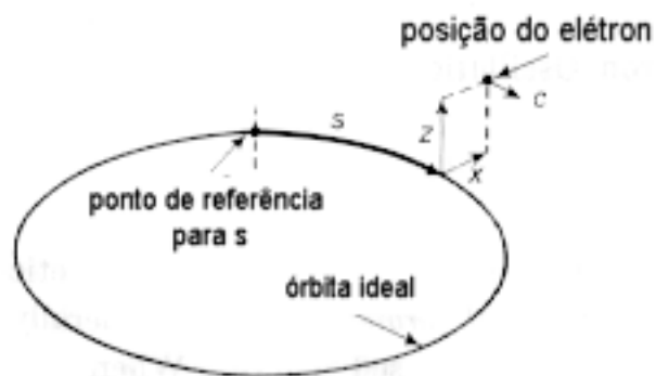
Fig. 1 : Sistema de referência utilizado para descrever o movimento de um elétron com relação à órbita ideal
