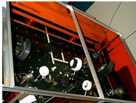
Foto 3.2: Fig. 3: Foto da montagem para gravação em LASER de Ar operando em UV
