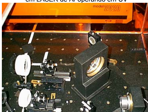
Foto 3.4: Posicionamento dos filtros espaciais e lentes convergentes
