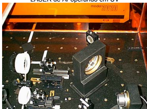
Foto 3.3: Posicionamento do espelho, semi-espelho, piezoelétrico, filtros espaciais, lentes convergentes e fris.
