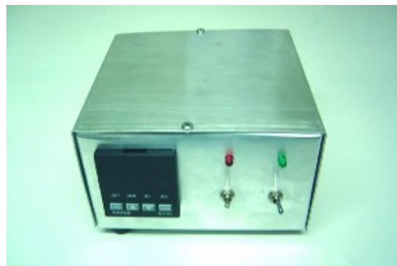
Figura 8: Câmera de alumínio com os componentes do circuito de desligamento do RTP.
