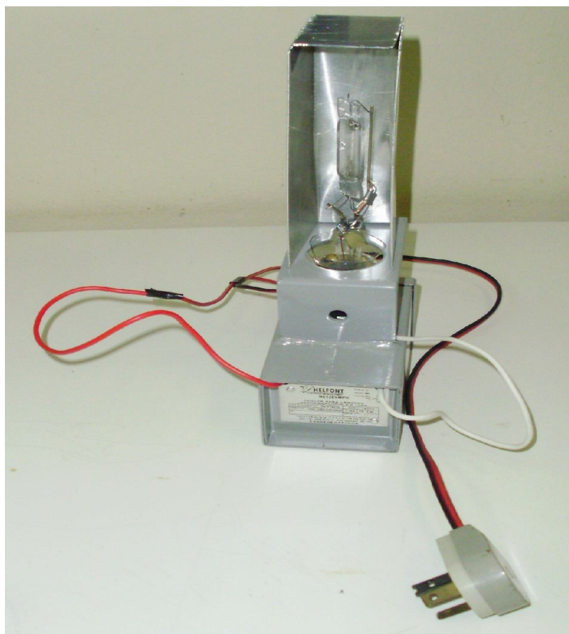
Figura 2. Interior da lâmpada de vapor de mercúrio.
