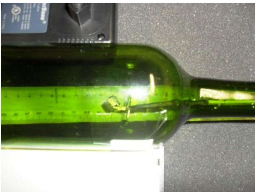
Figura 23: O microfone dentro da garrafa é deslocado de passos de 1 cm.
