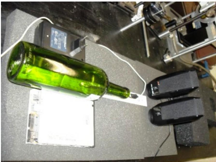
Figura 22: Montagem para a medida 3 dos ventres e nós de pressão.
