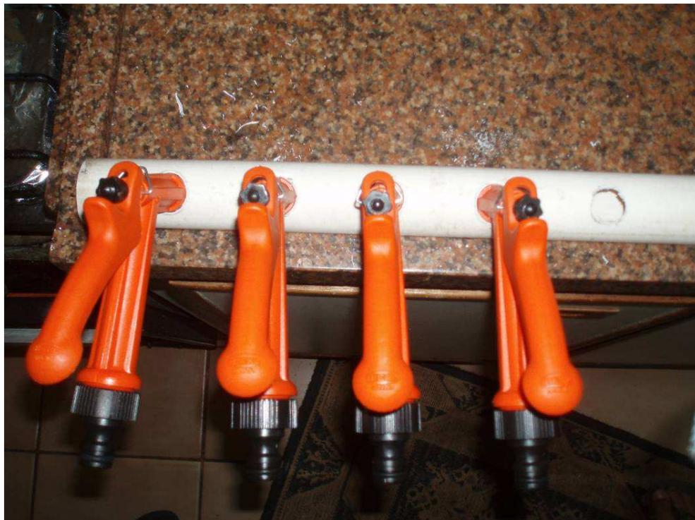
Figura 6: Esguichos fixados no tubo de PVC.
