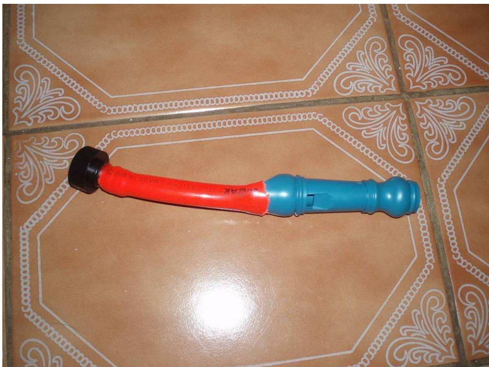
Figura 7: Sistema de interligação entre o esguicho e a boca de flauta.
