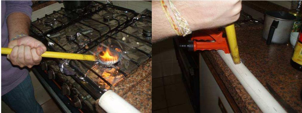
Figura 5: Processo de perfuração do tubo de PVC.
