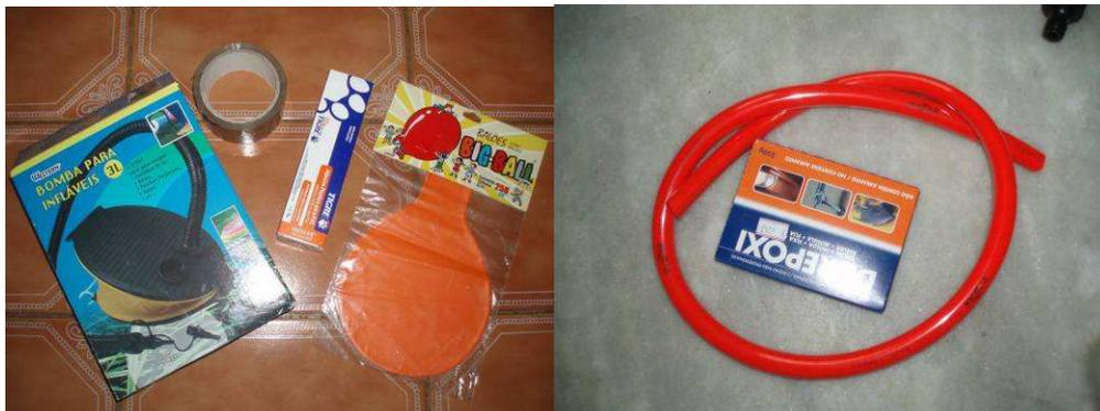
Figura 4: Bomba de ar cola adesiva para plástico PVC, massa do tipo Durepoxi, balão grande de festa, fita adesiva e mangueira.
