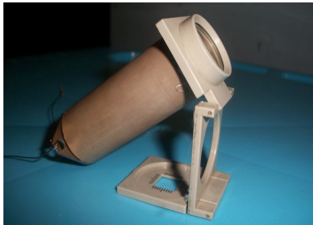
Figura 3: Tubo de PVC com a lente e o fototransistor montados
