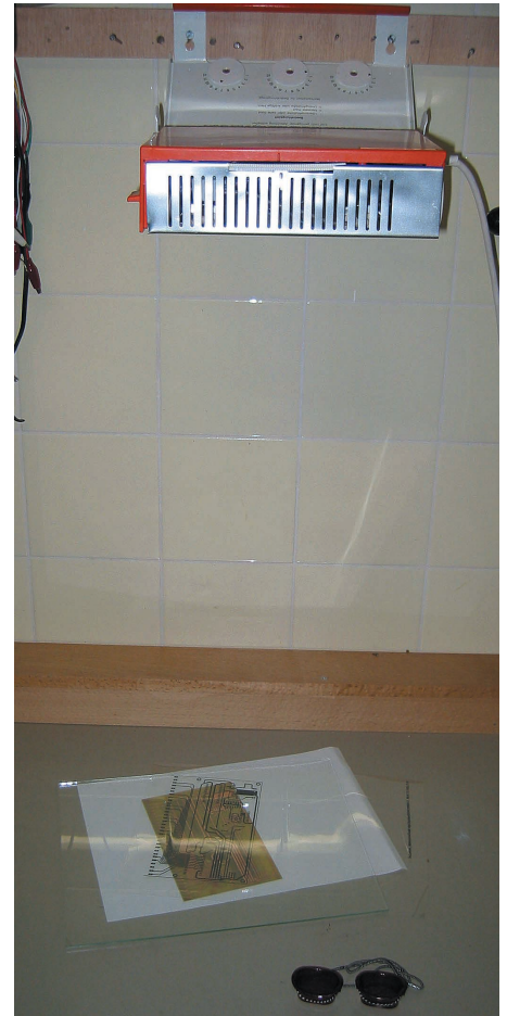
Figura 2. Exposição de uma placa com um aparelho de bronzear.
