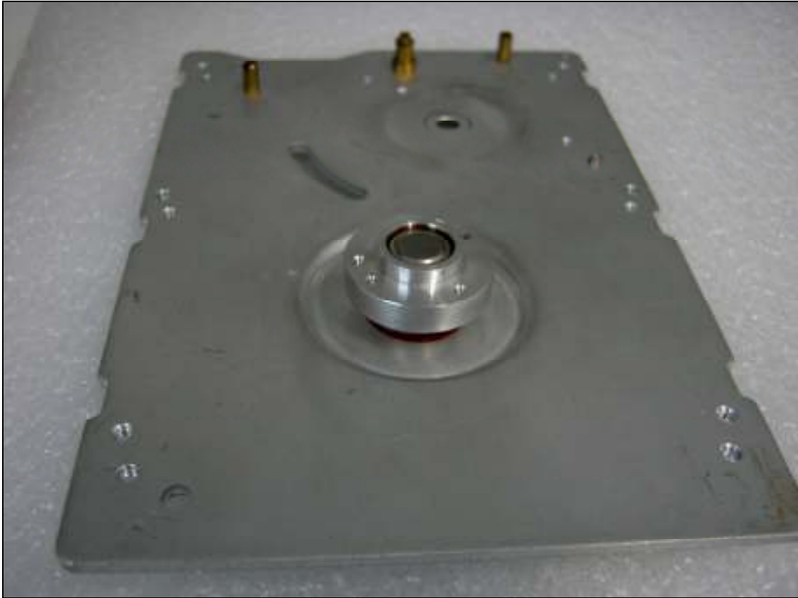
Figura 9: Mancal de disco rígido utilizado para construir o apoio do parafuso
