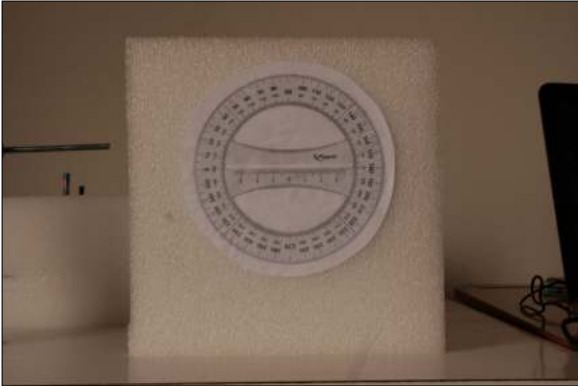
Figura 5: Anteparo utilizado para medir o ângulo de rotação do eixo do conjunto disco-motor.
