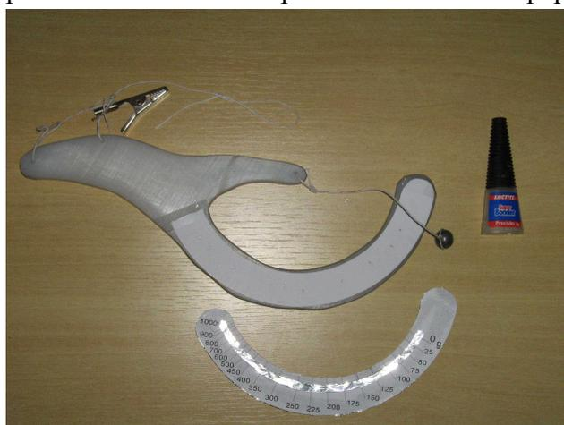
**Figura 5: Balança com aro a ser retirado, cola e escala deitadas sobre a mesa**
