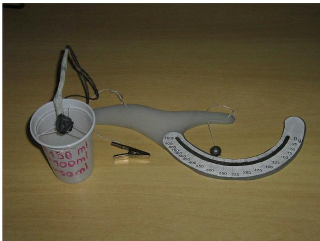
**Figura 9: Balança de correio e copo graduado**
