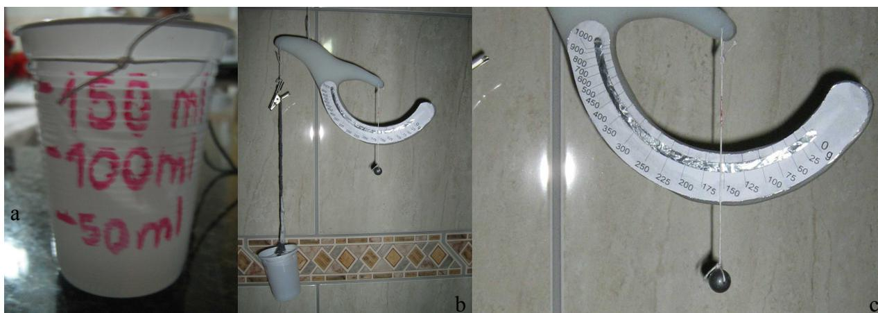
**Figura 12: Medindo a massa de 150ml de água**
