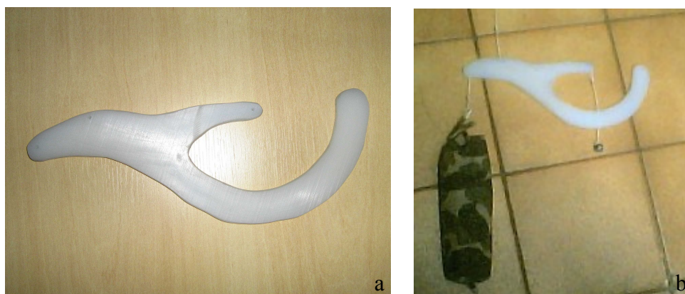
Figura 2: a)corpo da balança logo após usinagem; b)balança funcionando sem escala.
