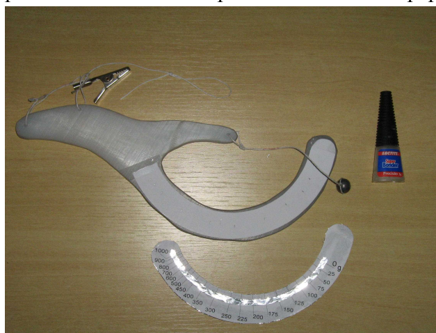
Figura 5: Balança com aro a ser retirado, cola e escala deitadas sobre a mesa
