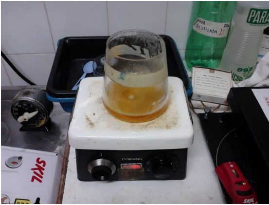
Figura 1 – Aquecimento e agitação da emulsão.
