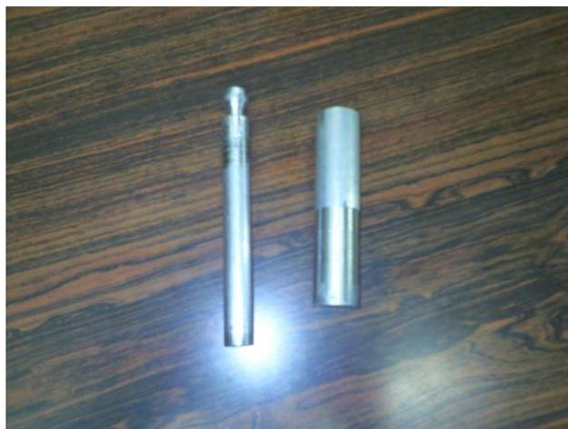
Imagem 5: Material de alumínio para confeccionar as peças a serem soldadas na panela.
