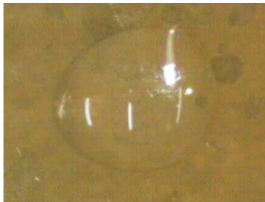
Fig.9.2. CTAB sobre a mica após alguns segundos
