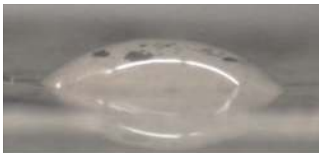
Fig.10. Imagem lateral da gota de CTAB sobre a mica.
