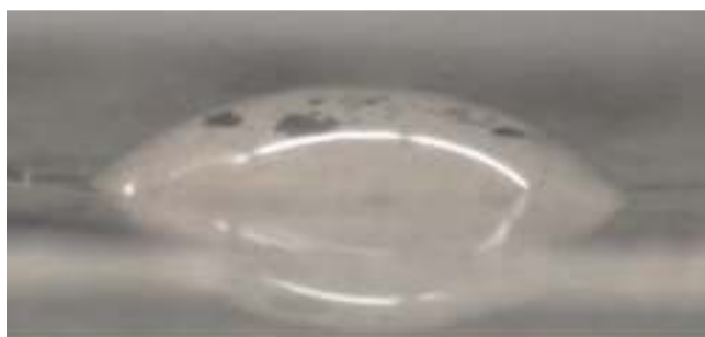
Fig.3. Imagem lateral em preto e branco de uma gota sobre a superfície.
