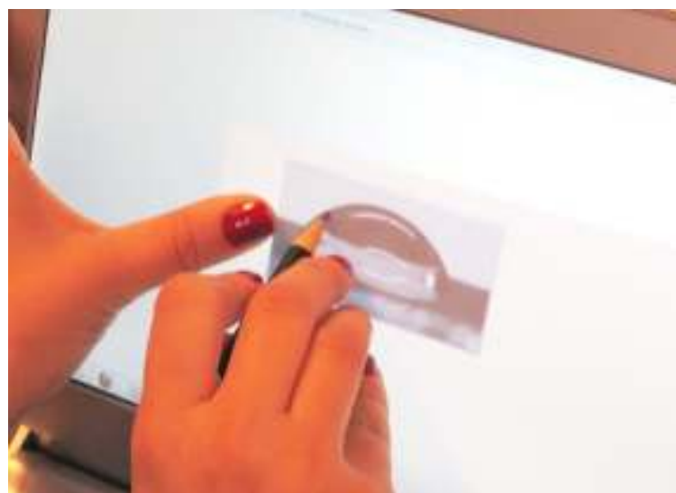
Fig.5. Risco da imagem da gota com um papel vegetal
