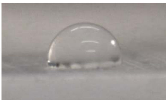
Fig.18. Imagem lateral do CTAB sobre o teflon
