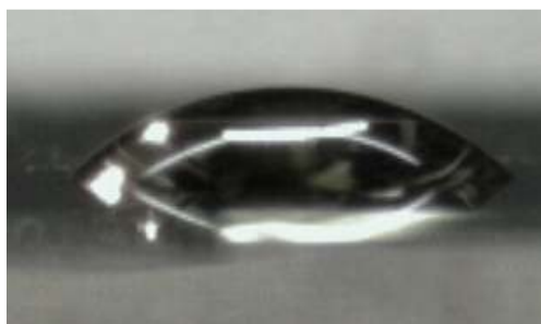
Fig.32. Imagem lateral do CTAB sobre o ouro
