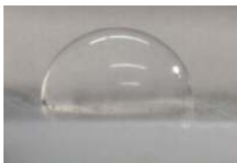
Fig.20. Imagem lateral do SDS sobre o teflon
