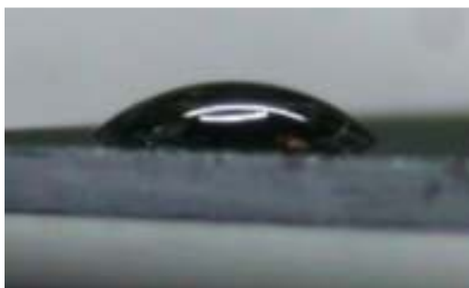
Fig.25. Imagem lateral do CTAB sobre o silício
