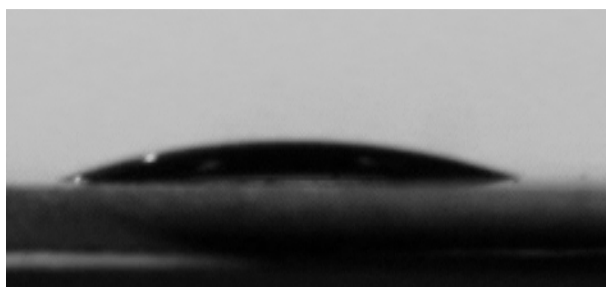
Fig.27. Imagem lateral do SDS sobre o silício
