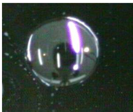
Fig.24.2. CTAB sobre o silício após alguns segundos
