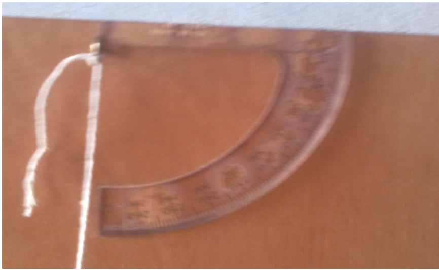
Figura 1 – transferidor (para medir o ângulo do pêndulo)
