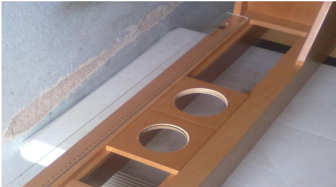
Figura 3 – trilhos, régua graduada (medidora do alcance) e coletores com dois diâmetros diferentes
