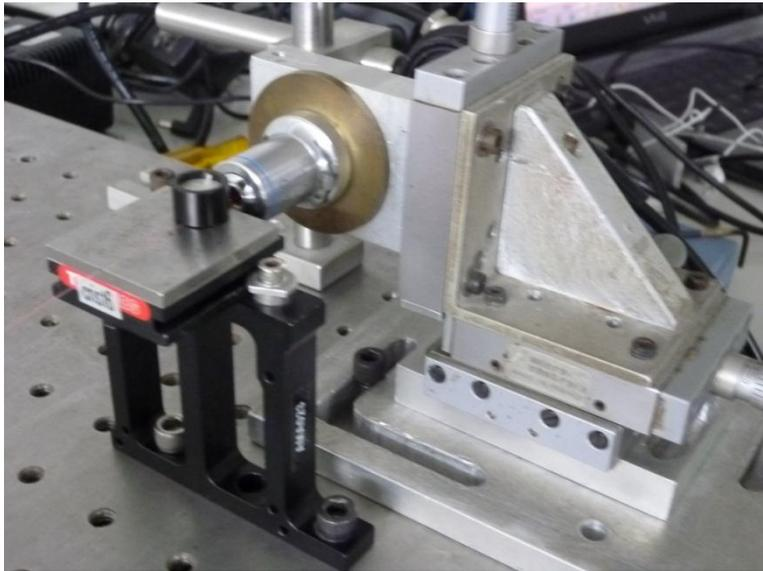
*Figura 8: Lente para fazer o campo de iluminação do laser aumentar (divergir).*
