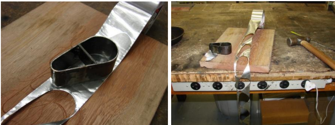
O setor é cortado batendo a ferramenta contra uma madeira (estampagem) usando um martelo
