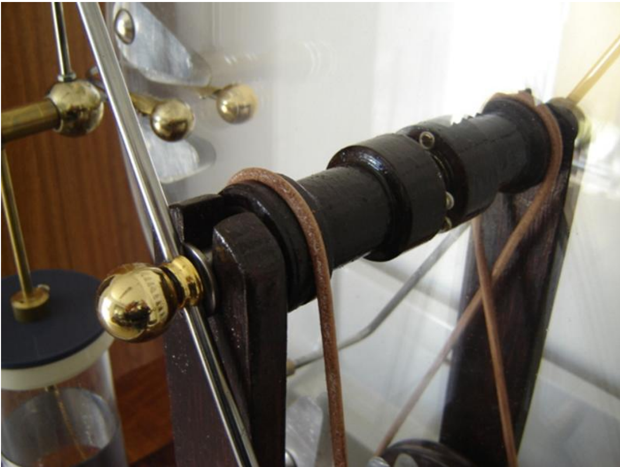
Vista detalhada dos bosses e suporte de sustentação dos discos de acrílico. Os bosses forma torneados em teflon e pintados de marrom para parecerem madeira.
