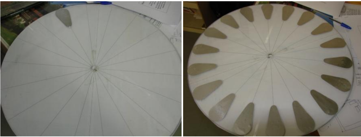
Primeiro setor sendo colado no acrílico. Pode-se ver o desenho no papelão abaixo dele; disco com todos os setores colados.
