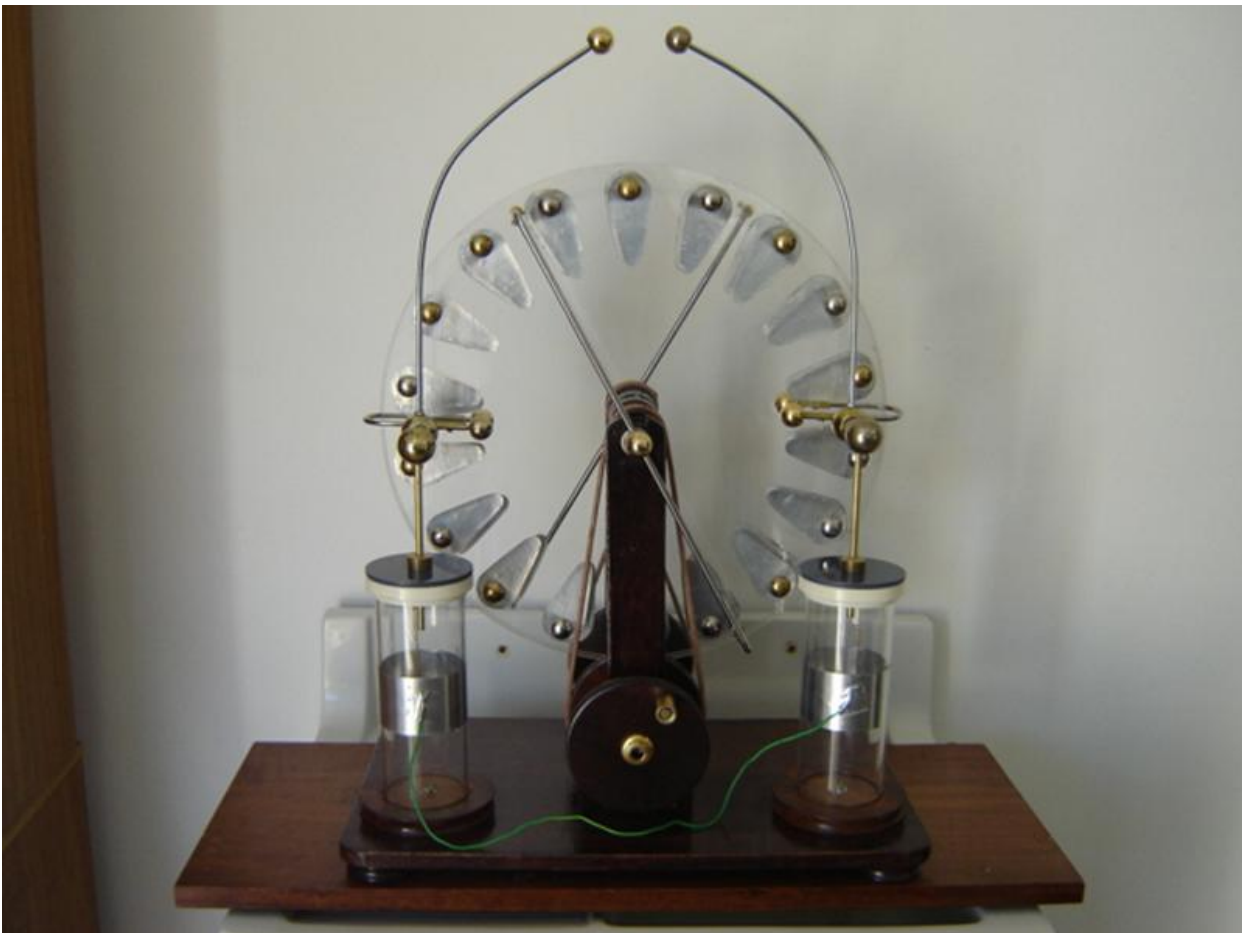
A máquina com os novos capacitores já montados no lugar. Falta ainda a conexão definitiva
