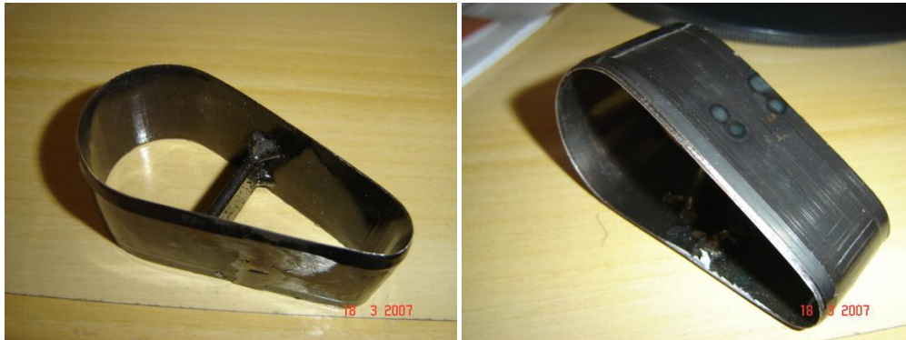
Ferramenta de corte mandada construir para a fabricação dos setores
