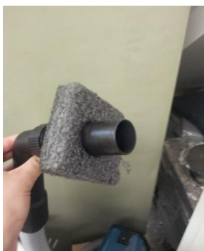
Foto5: sistema provisório de vedação.
