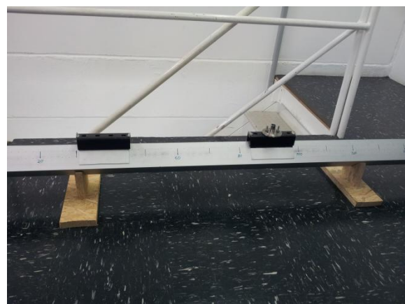
Foto9: montagem para colisão.
