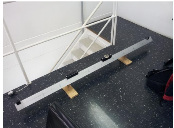
Foto8: montagem para colisão.
