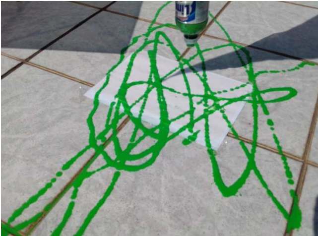
fig. 5: padrão aleatório de deposição de tinta.
